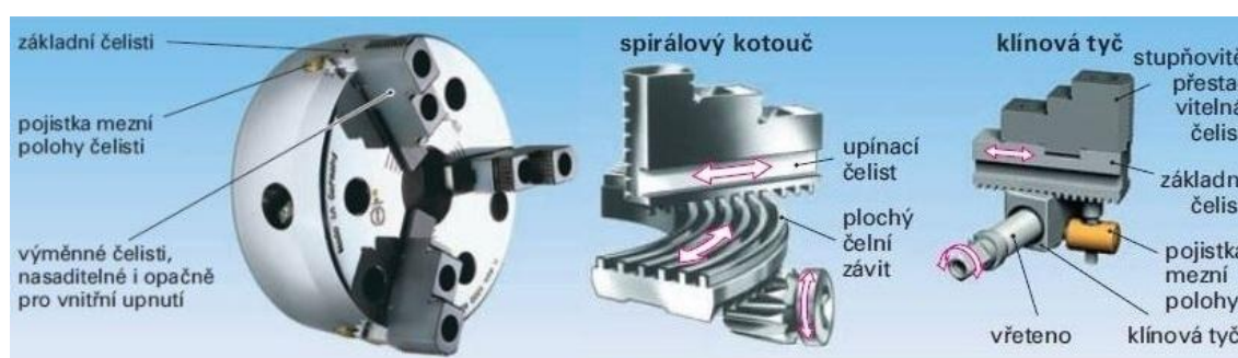
Obr. 13: Popis tříčelistového sklíčidla a mechanismus utahování sklíčidla [16]
