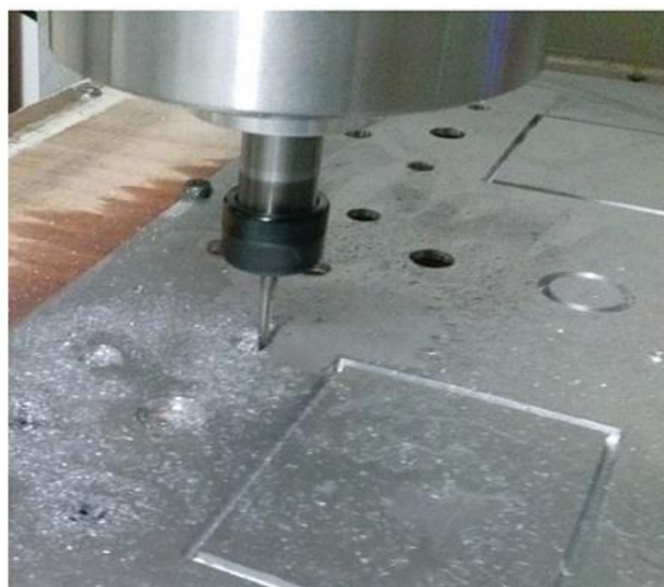
Obr. 52: Výroba predného panela laboratórneho zdroja na CNC fréze
