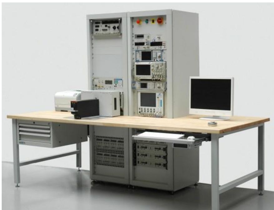
Obr. 2: Usporiadanie testovacieho pracoviska - montáž napájacích zdrojov do 19" systému, prevzaté z [41]
