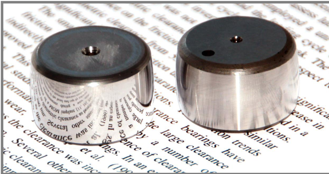
Obr. 5-2 Porovnání vyleštěného (vlevo) a nevyleštěného soudečku (vpravo)
