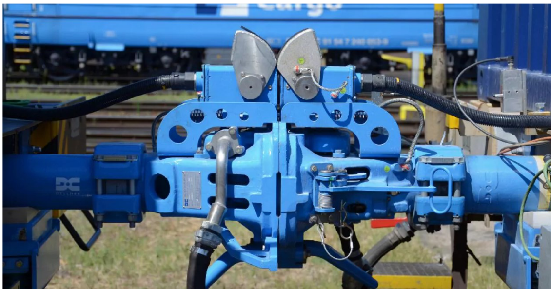
Obr. 4.2 Digitální automatické spřáhlo
