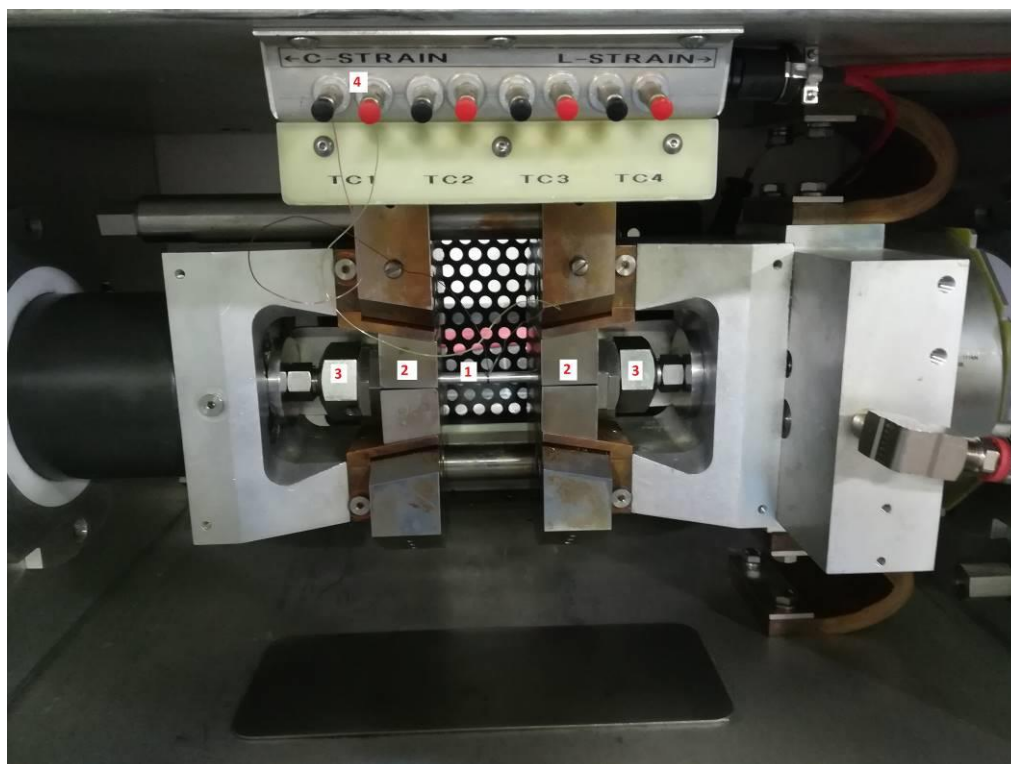
Obr. 38 Upnutý zkušební vzorek v pracovním prostoru stroje 1)zkušební vzorek, 2)klínové čelisti, 3)rozpěrné šrouby, 4) kanál pro upnutí termočlánků
