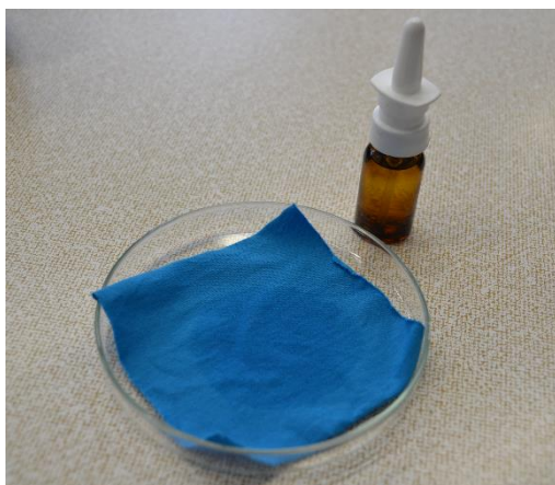
Obrázek 39: Aplikace syntetického potu na vzorek nosním sprejem[vlastní]
