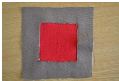
Obrázek 44: Nastavení testovaného vzorku tkaninou[vlastní]
