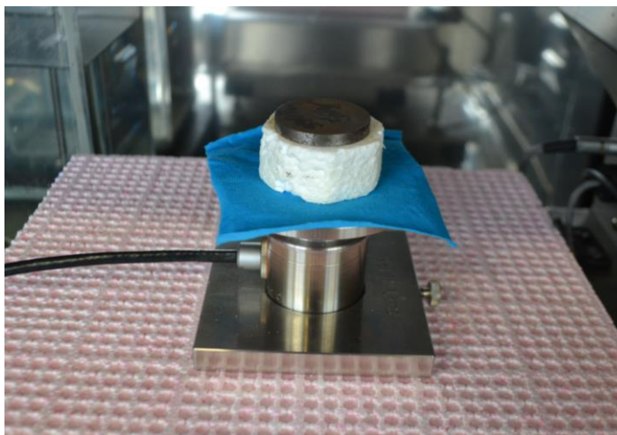
Obrázek 40: Ukázka průběhu měření na přístroji C-Therm TCi[vlastní]
