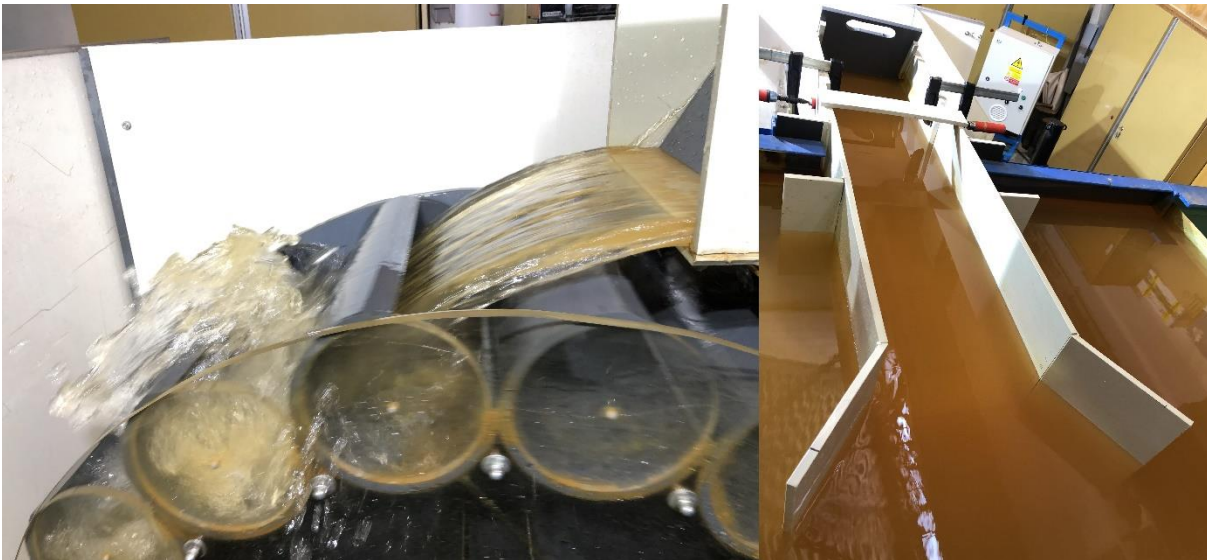
Obr. 3.5 Proudění žlabem po přidání regulační desky
