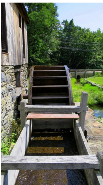
Obr. 2.12 Nátok na historické vodní kolo se středním nátokem [24]
