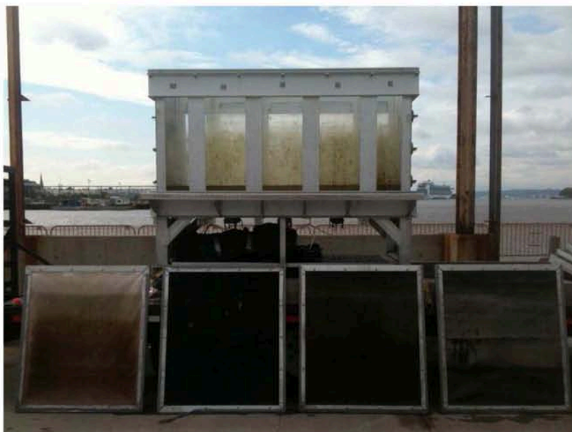
Filtrační membrány po vytažení z nádrže
