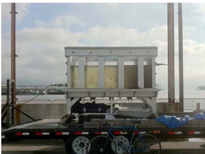
Filtrační membrány byly osazeny do nádrže. Do její pravé části je přiváděna voda z řeky, směrem k levé části dochází skrz membrány k jejímu čištění
