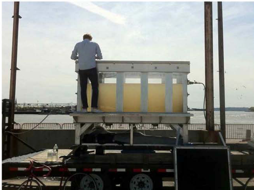
Nastavení nádrže a filtrů - čištění kalné říční vody
