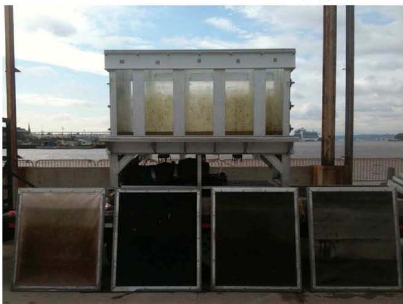
Filtrační membrány po vytažení z nádrže
