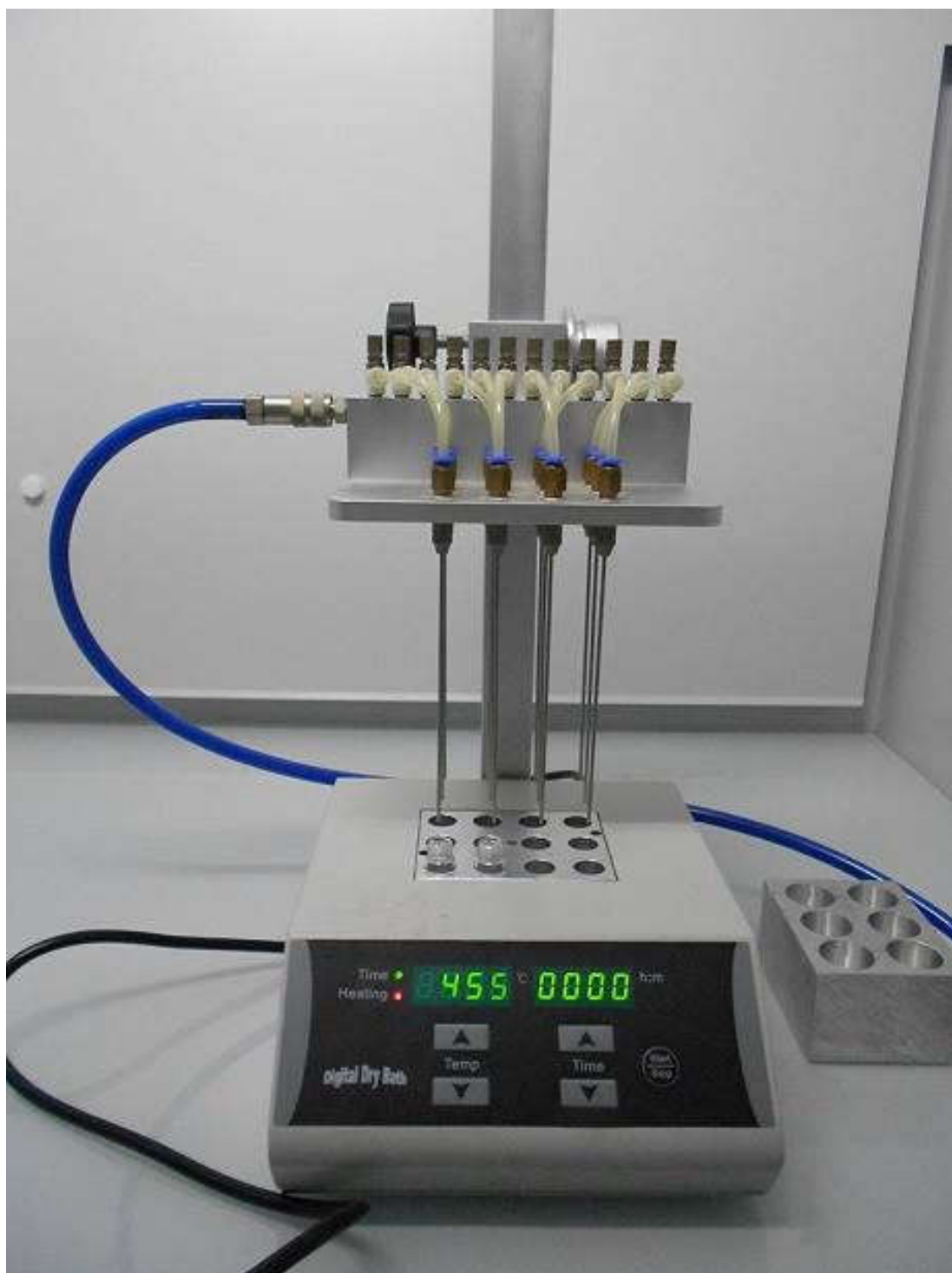
Obr. 16 Odpařování eluátu dusíkem pomocí koncentrátoru EVATERM při 45,5 °C
