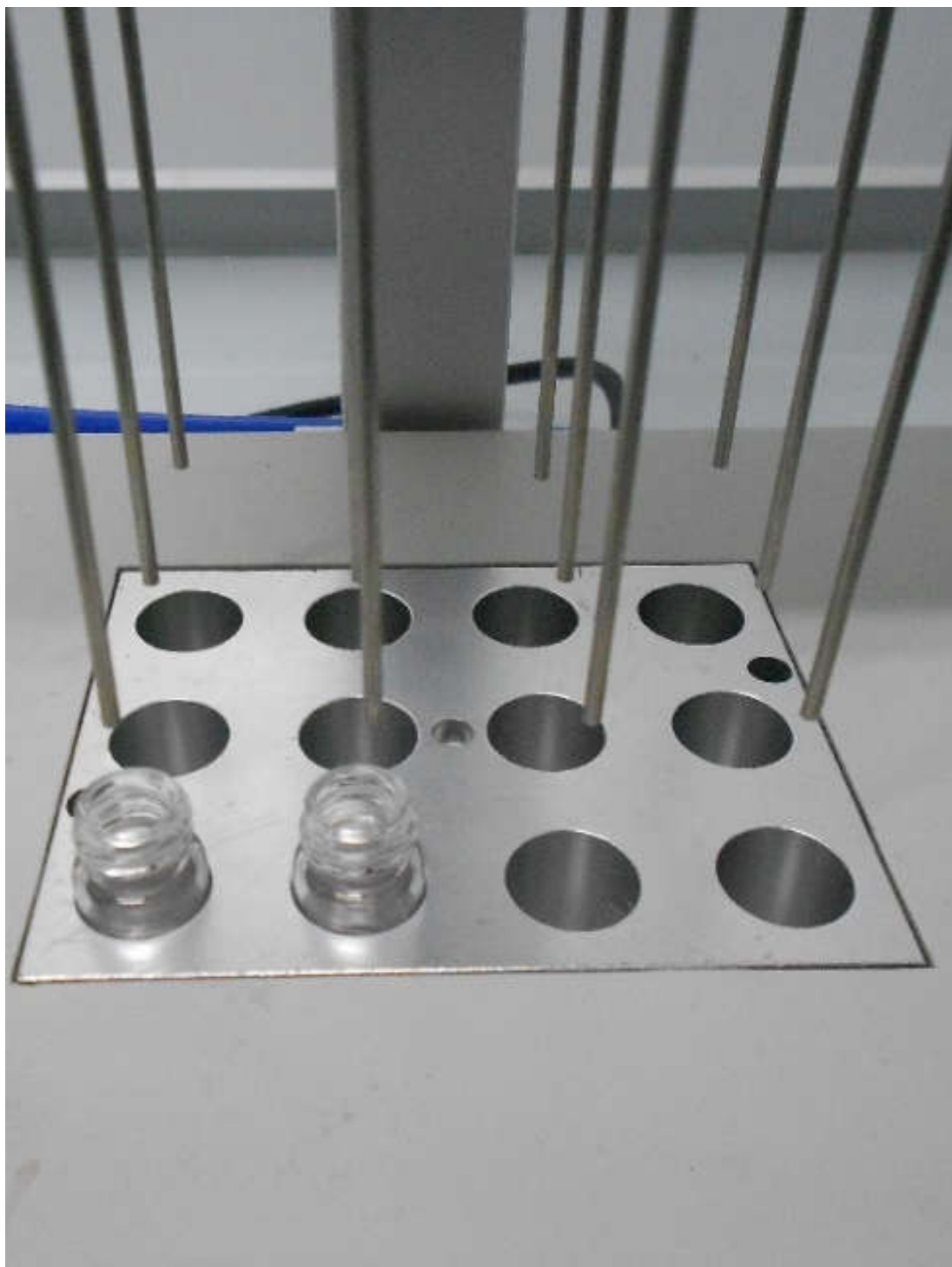
Obr. 17 Detail na vialek s eluátem odpařovaným dusíkem
