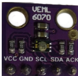
Obr.13: Senzor VEML6070 využitý pro měření UV záření.
