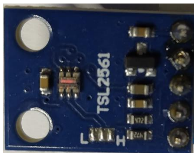
Obr.15: Senzor TSL2561 využitý pro měření okolního osvětlení.
