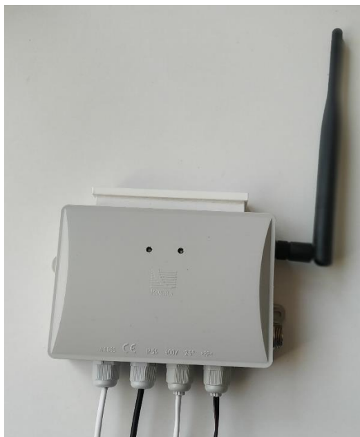
Obr.21: Krabička s integrovaným hlavním modulem.
