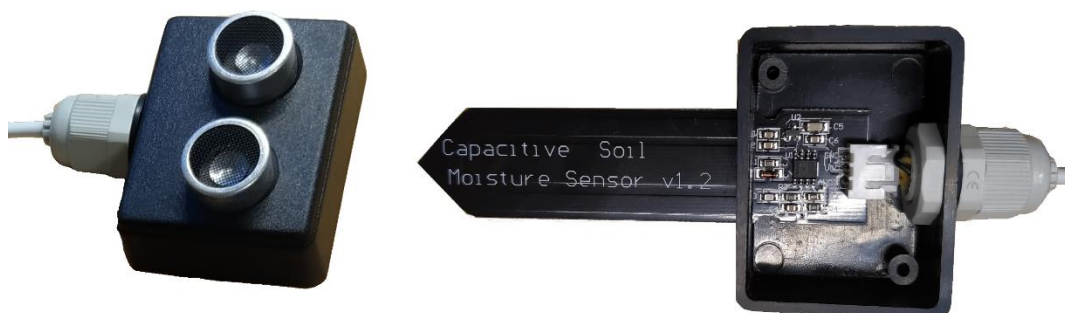
Obr.22: Senzory pro měření hladiny vody a půdní vlhkosti zabudované v krabičkách.
