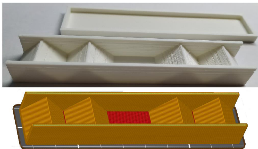
Obr.23: Vytištěná krabička na 3D tiskárně (nahore), návrh krabičky se zobrazením vrstev v programu PrusaSlicer.
