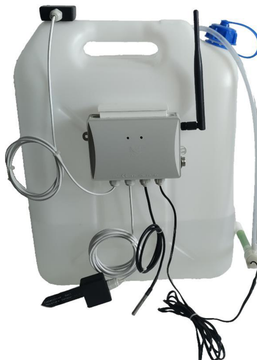
Obr.24: Výsledné provedení modulu pro odesílání dat včetně všech komponent.
