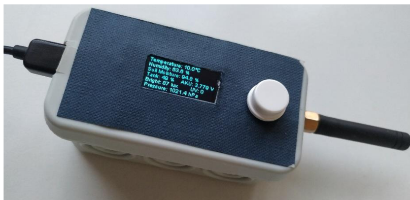
Obr.31: Výsledné provedení modulu pro příjem dat zabudovaného v krabici.
