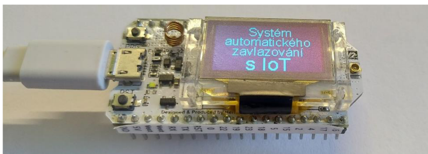
Obr.6: Využitý vývojový kit LoRa WiFi kit V2 pro příjem dat.
