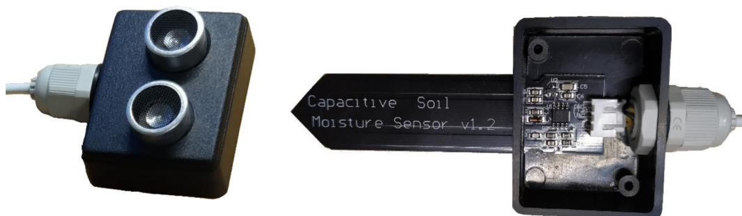
Obr.22: Senzory pro měření hladiny vody a půdní vlhkosti zabudované v krabičkách.
