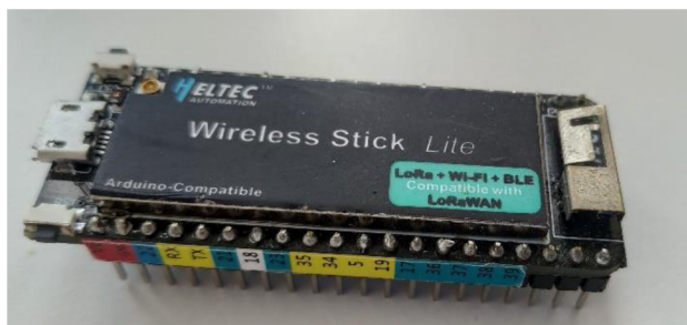
Obr.5: Využitý vývojový kit Wireless Stick Lite pro odesílání dat.
