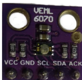
Obr.13: Senzor VEML6070 využitý pro měření UV záření.
