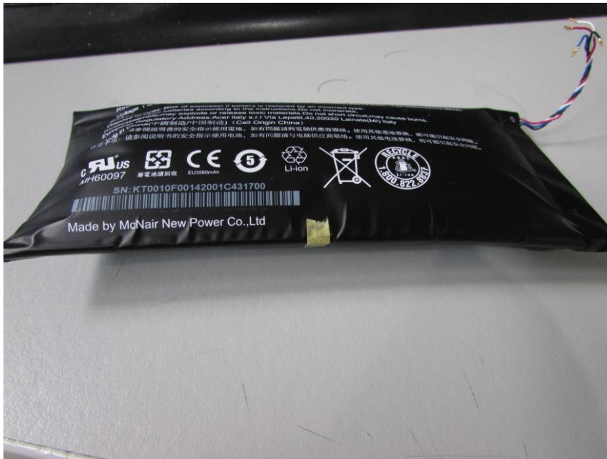
Obr. 2 Lithium-iontový akumulátor tabletu nafouklý v důsledku kontaminace během výroby [autor]
