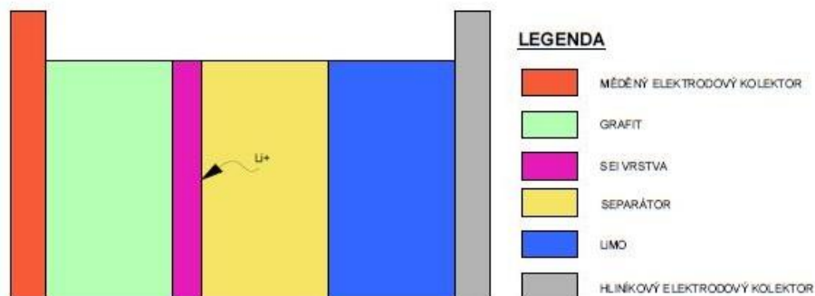
Obr. 7 SEI vrstva u záporné elektrody na bázi grafitu [8]
