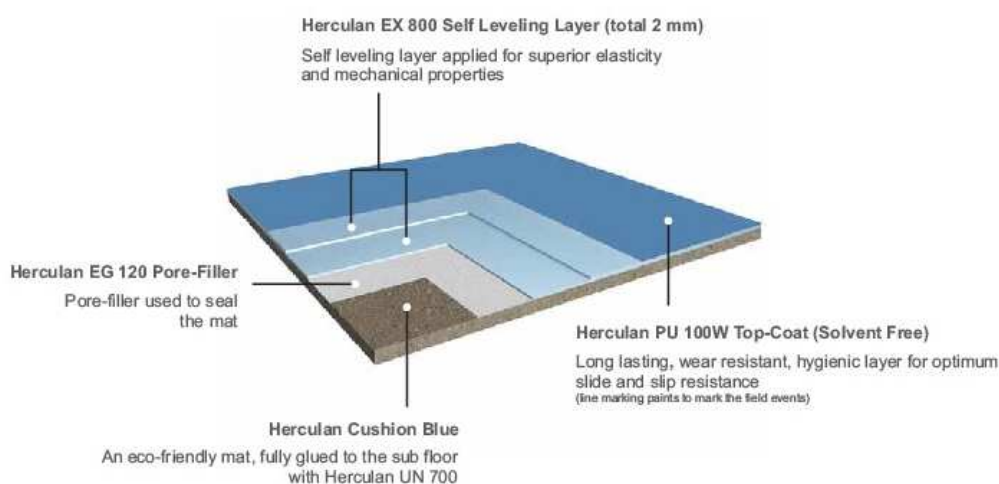
Obr. 23: Schéma vrstev sportovní podlahy Herculan
