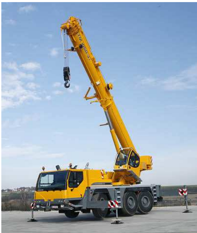
Obr. 6: Autojeřáb Liebherr LTM 1050
