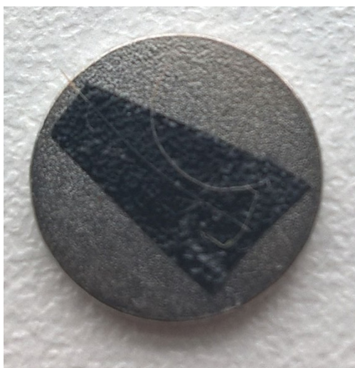
Obrázek 3. Kovová podložka s černou oboustrannou lepící páskou, na níž je vzorek vlasu a řasy použitý pro měření.
