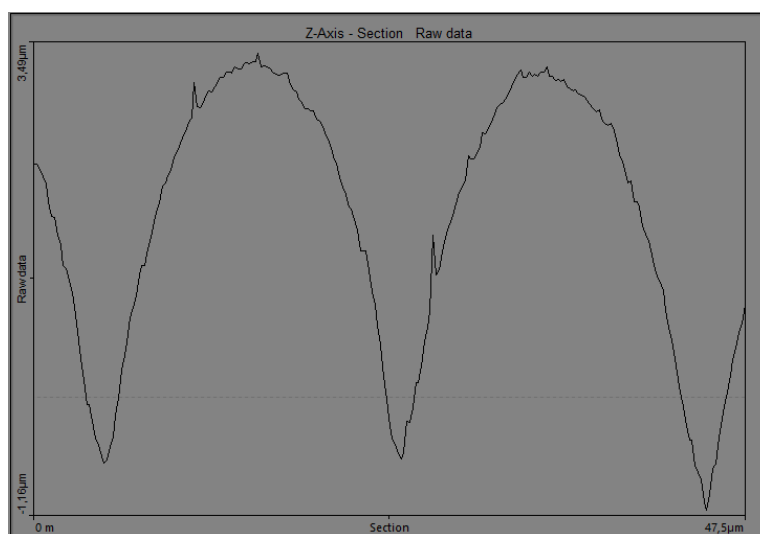
Obrázek 3.4.3.2. Obrázek grafu k měření vzdálenosti dvou oček. Nerovnosti křivky představují artefakty a drobné nečistoty. Opět je třeba dát pozor na různá měřítka u svislé a vodorovné osy.
