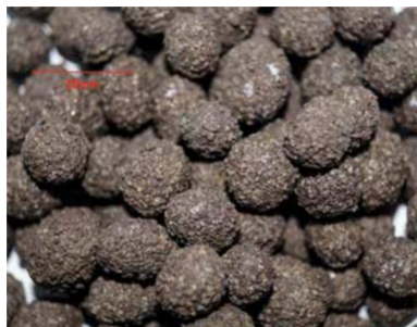
Obrázek 2.19 KRAFTBLOCK – Ukázka použitého materiálu [26]
