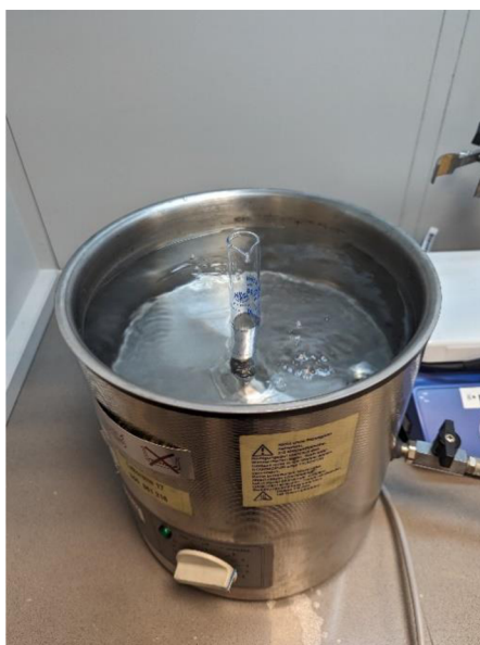
Obrázek 5.6 Odměrný válec v ultrasonickém čističi
