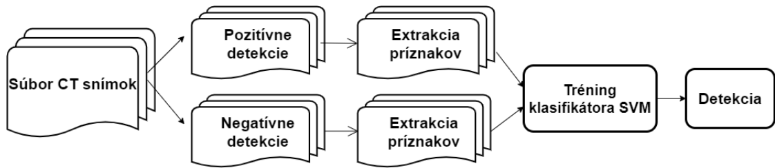
Obr. 6.3: Genéza detekčného algoritmu
