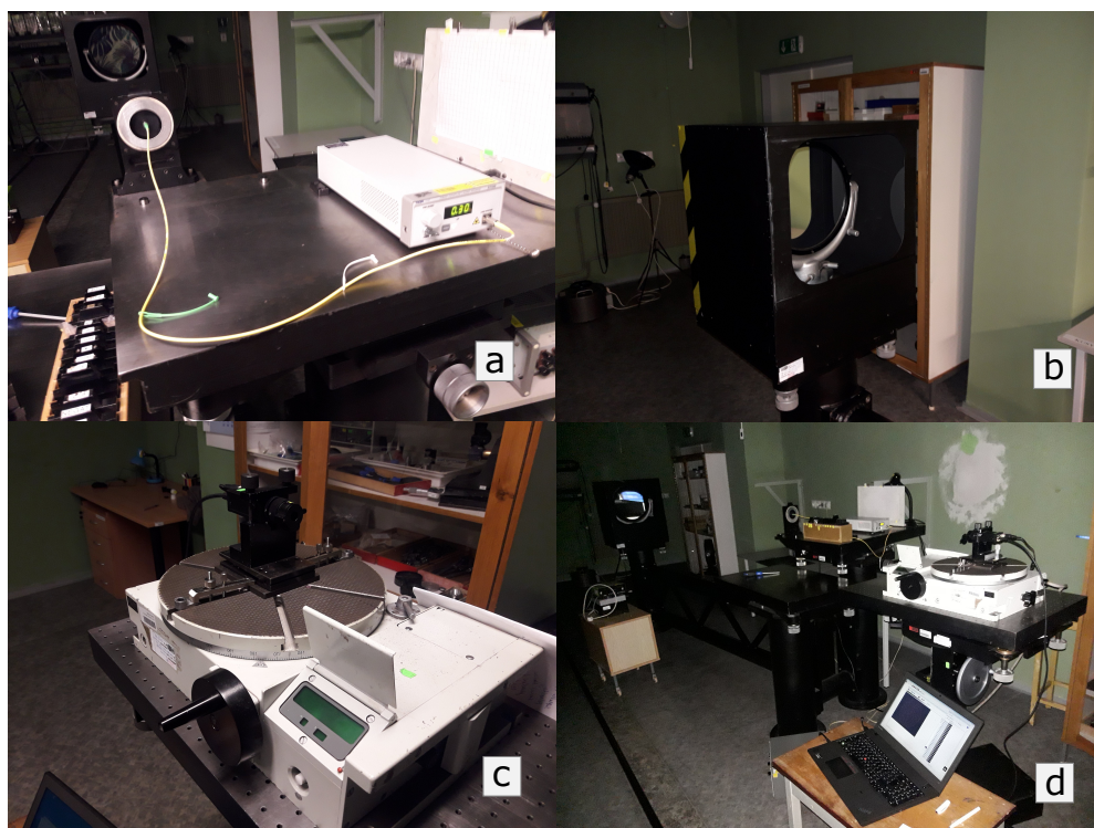
Obrázek 27: Reálné uspořádání experimentálního měření. a)-laserový zdroj pracující na vlnové délce 635 nm s optickým vláknem vedoucím do ohniskového bodu parabolického zrcadla kolimátoru; b)-parabolické zrcadlo kolimátoru; c)-goniometr sloužící k realizaci náklonů; d)-Celkový pohled
