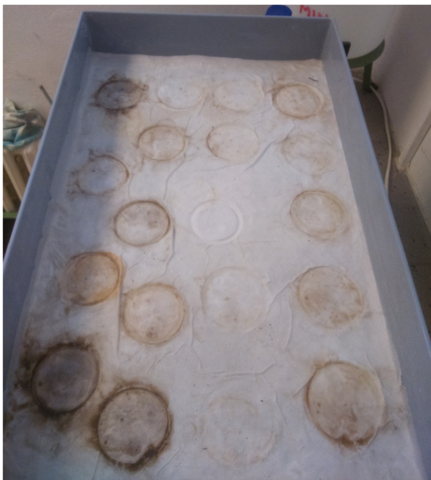
Obr. 29: Snímek dokumentující pískový tank po vyjmutí vzorků z druhé série. Kombinace kolon a rostlého terénu. Místa s nulovým nebo minimálním výluhem připadají vzorkům odebraných přímo z rostlého terénu. Největší výluh připadá na vzorky s BC a kombinací AMO + BC (dolní roh) a také kombinace AMO + BC (horní roh). Jediný výrazně světle hnědý výluh (druhý od spodu) je ze vzorku obohaceného AMO.
