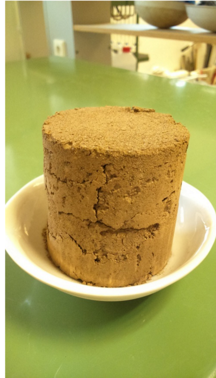
Obr. 14: Vzorek po vysušení bez válečku – pouze zemina, odběr kolona.
