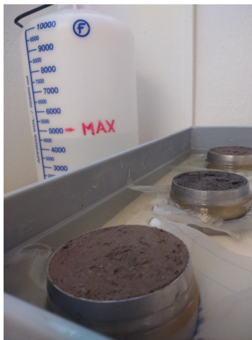
Obr. 9: Sycení vzorků v pískovém tanku s výškou hladiny vody 1 cm pod horní okraj vzorku.
