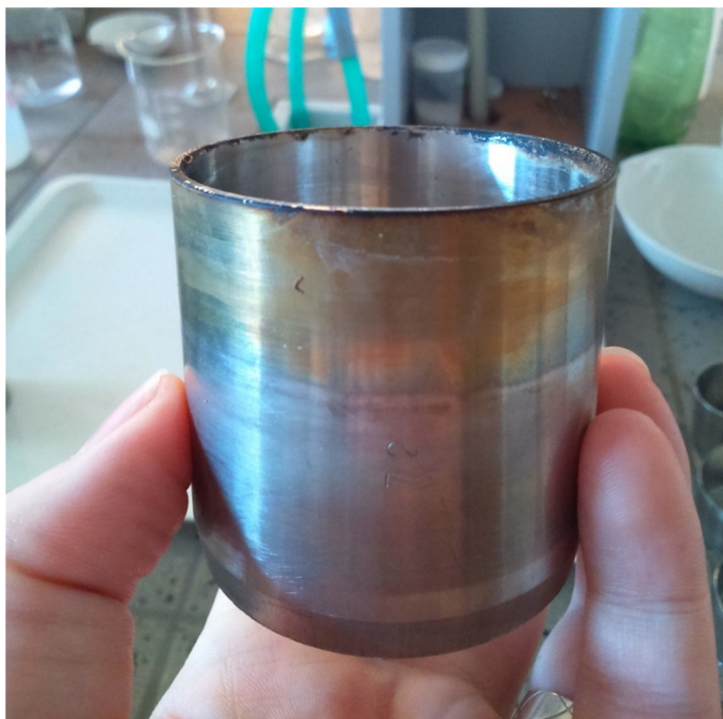
Obr. 31: Ten samý váleček jako na obr. č. 30. Ovšem po celém procesu měření, tedy i po vysušení a výluhem kontaminantů obsažených v půdě. Jedná se o vzorek z první série, kde byla půda obohacena 2% BC.
