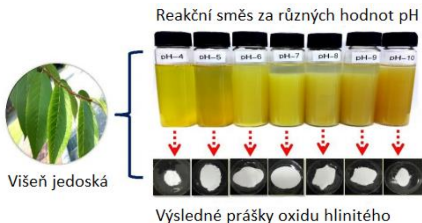
Obrázek 3. Demonstrace odlišnosti zabarvení za různých hodnot pH. Manikandan [38], přeloženo.
