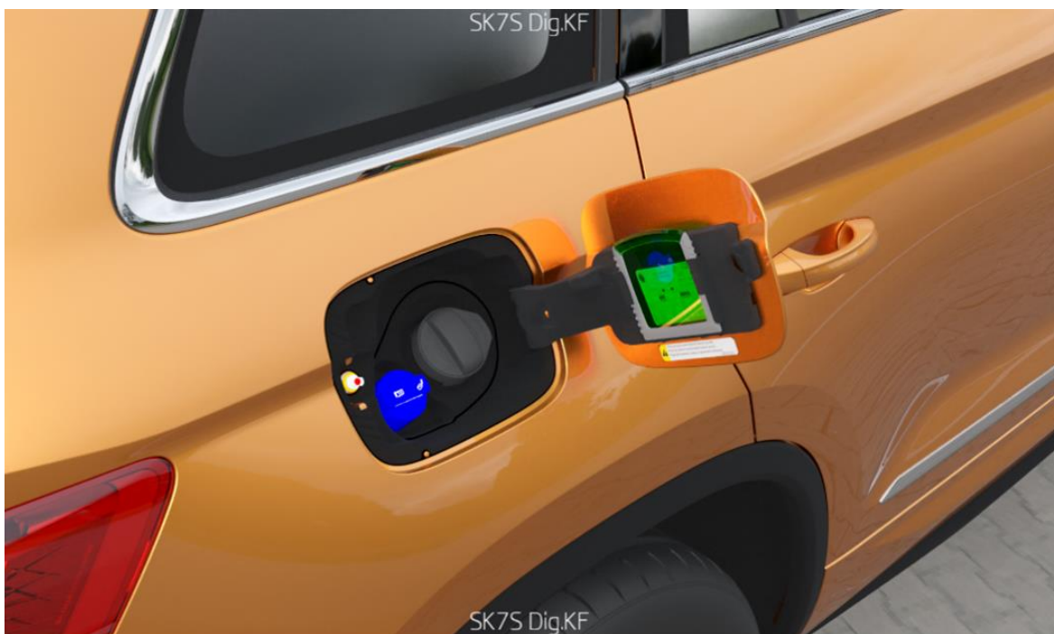
Obr. 17 Otevření víka nádrže pro škrabku na led
