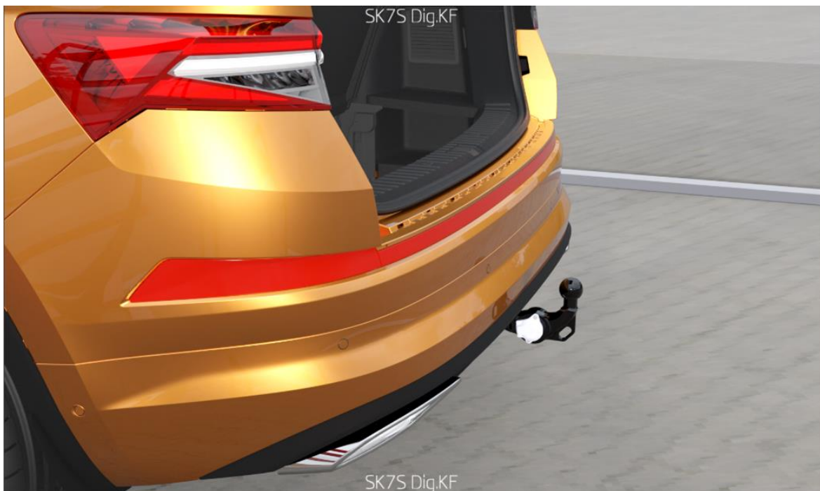
Obr. 16 Aretování tažného zařízení
