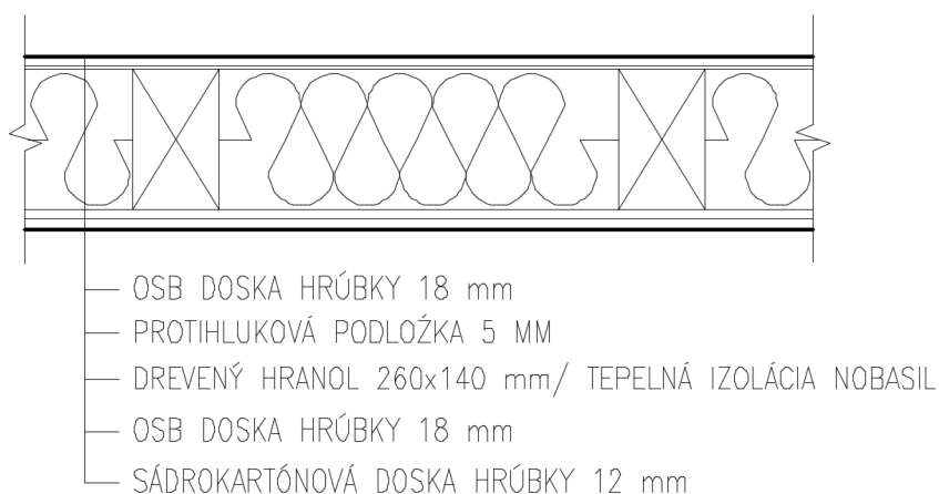
Obrázok 2 skladba stropu nad 1.N.P.
