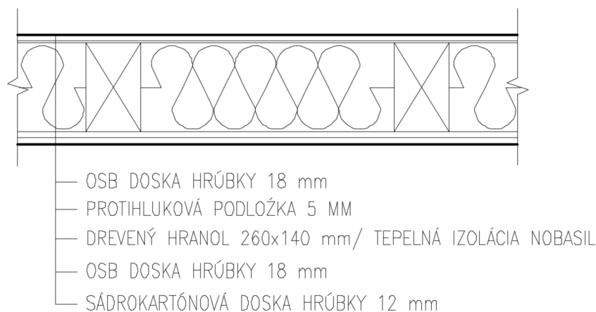
Obrázok 2 skladba stropu nad 1.N.P.
