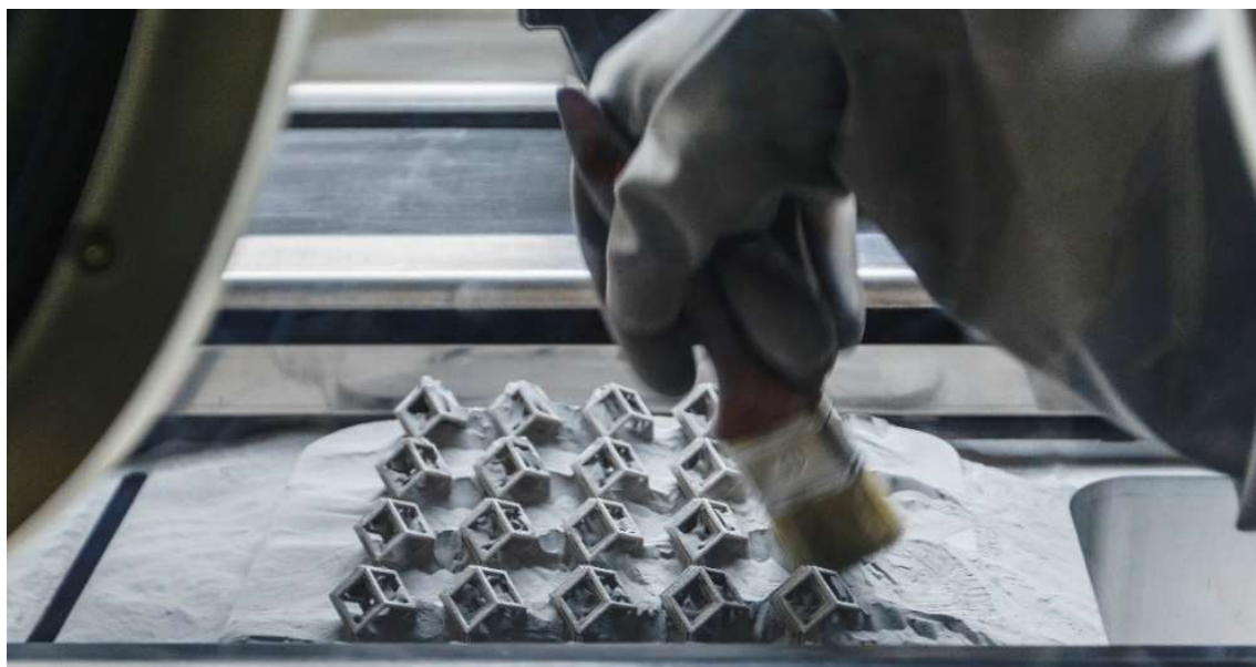
Obr. 12 Očišťování vytisknutých dílů [1]
