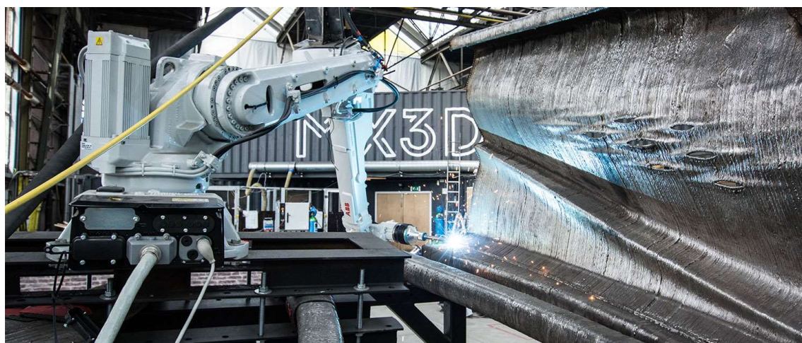
Obr. 38 Využití robota při tisku metodou WAAM-CMT [52]
