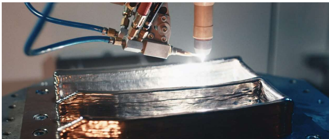
Obr. 23 Boční přívod materiálu u metody PMD [34]
