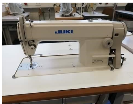
Jednojehlový šicí stroj se stehem dvounitým vázaným
