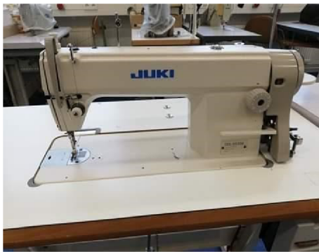
Jednojehlový šicí stroj se stehem dvounitým vázaným
