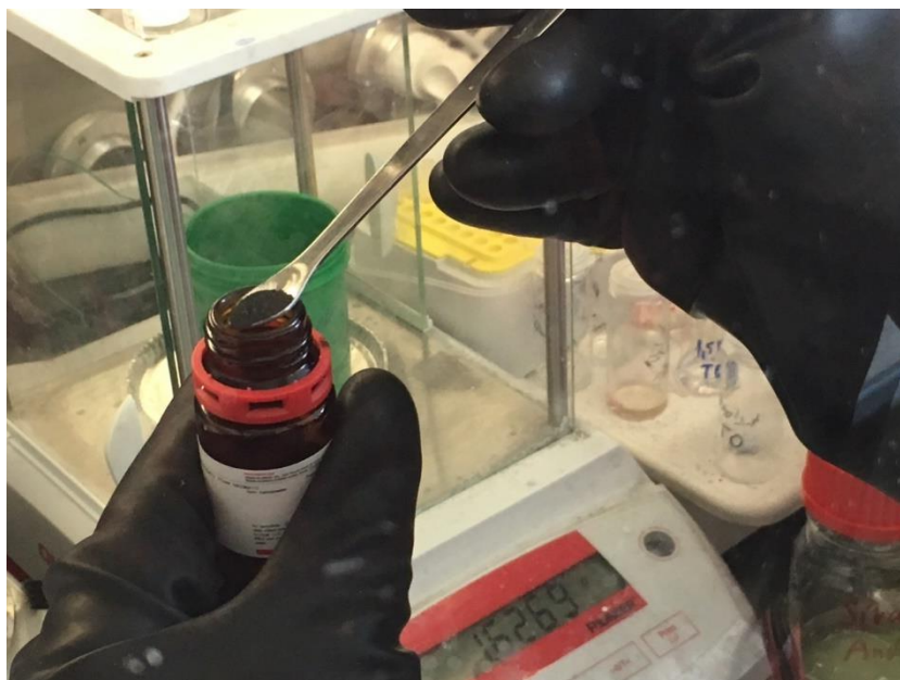
Obrázek 20: Vsypávání nanočástic do připravených vzorků
