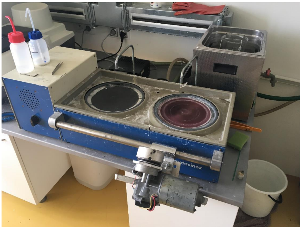
Obrázek 45: Rotační bruska a leštička Metasimex a vzadu čistička Kraintek
