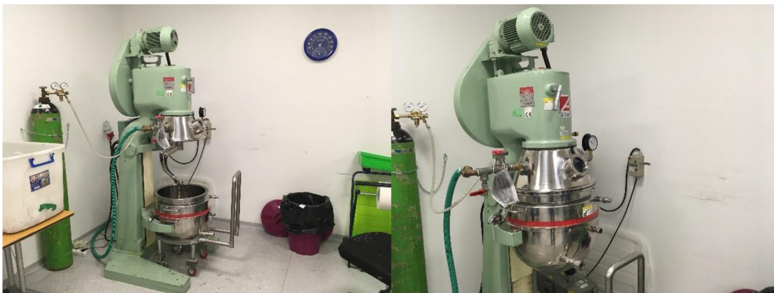
Obrázek 16: Zařízení na míchání pájecí pasty
