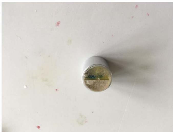
Obrázek 43: Vzorek zalitý dentacrylem ve formě
