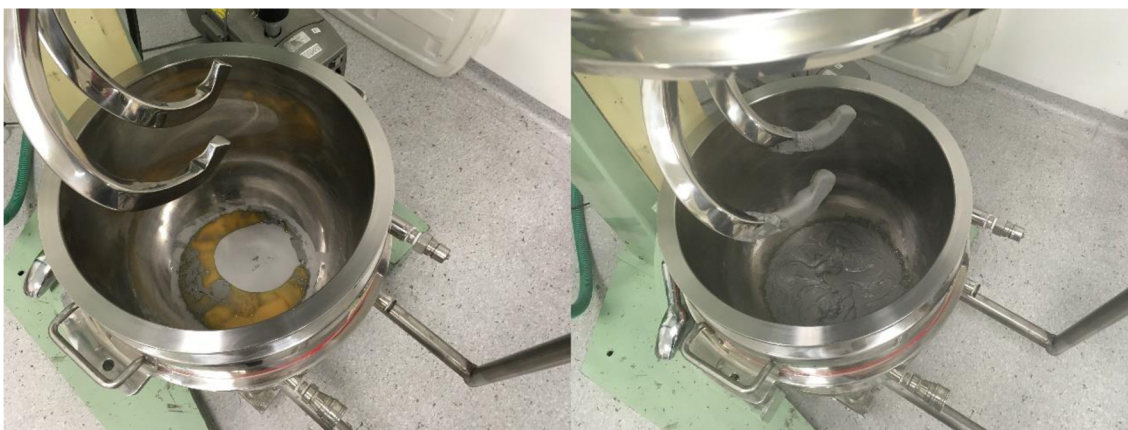
Obrázek 17: Na levém obrázku pasta před mícháním, na pravém po míchání
