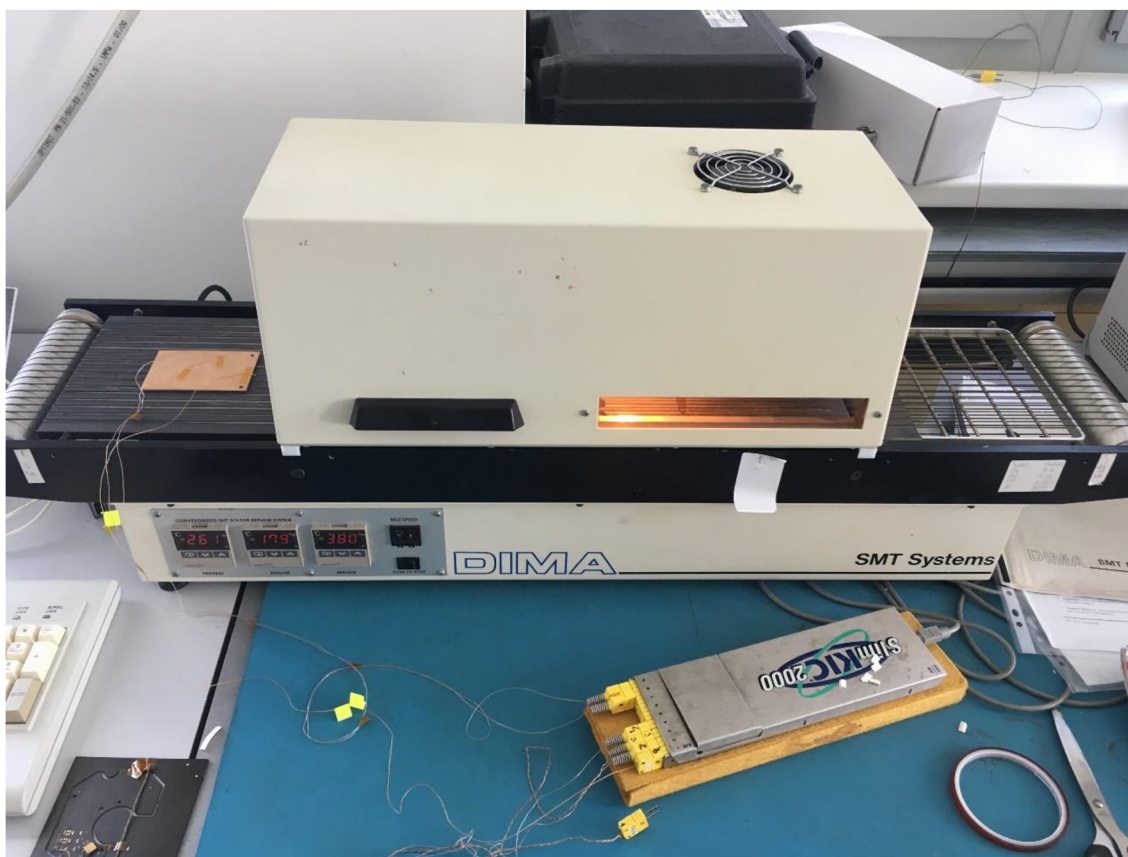
Obrázek 28: Příklad měření teplotních profilů
