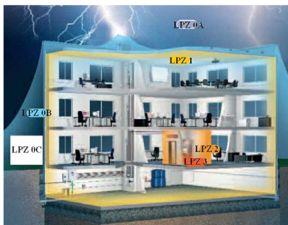
Obr. 5-1 Zóny ochrany pred bleskom [5]. Obr. 5-2 Rozmiestnenie SPD na rozhraní LPZ [5].
