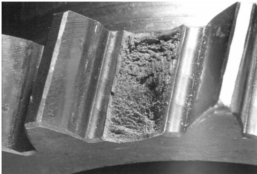
Obr. 2 – Selhání zubu vzniklé přetížením [3]
