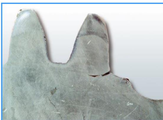
■ Únavová trhlina v patě zubu.
