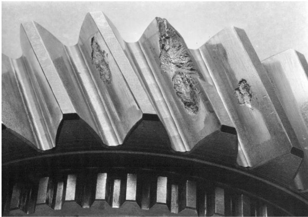
Obr. 4 – Poškození zubů vlivem makropittingů [3]
