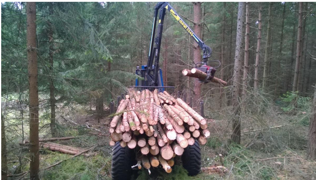
Příloha 14: Vimek 606TT při skládání nákladu na OM (vlastní fotografie)
