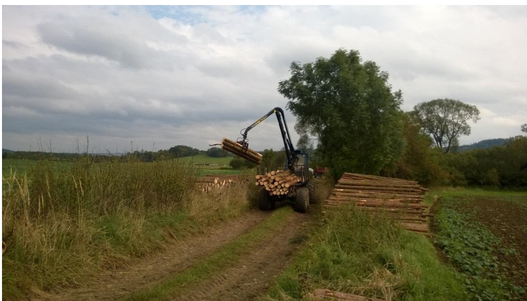
Příloha 14: Vimek 606TT při skládání nákladu na OM (vlastní fotografie)
