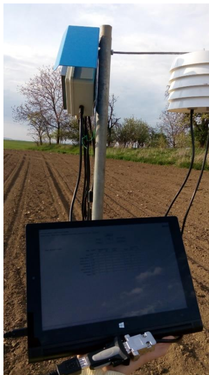
Obr. 4: Stahování naměřených dat v terénu (BUREŠ, 2016)
