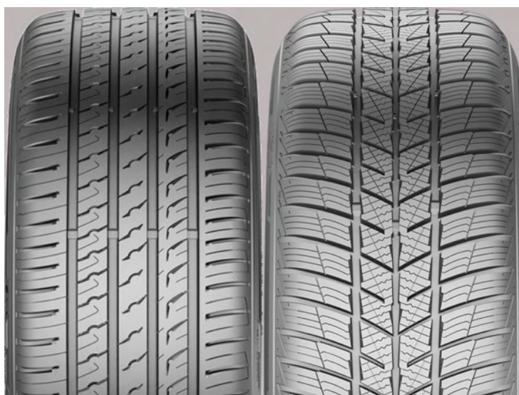
Obrázek č. 23 – Letní a zimní pneumatiky, čtyři nebo tři hlavní dezénové drážky [11]
