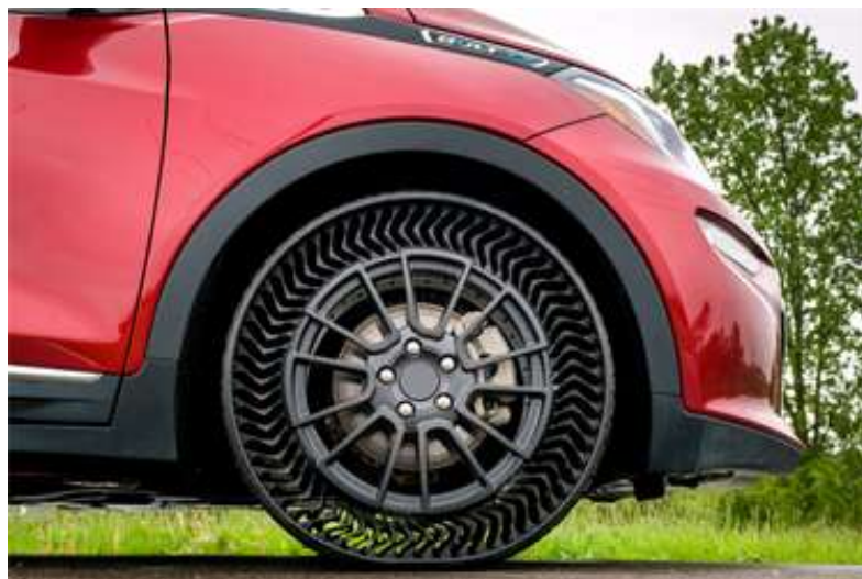
Obrázek č. 18 – Pneumatiky bez vzduchu [17]
