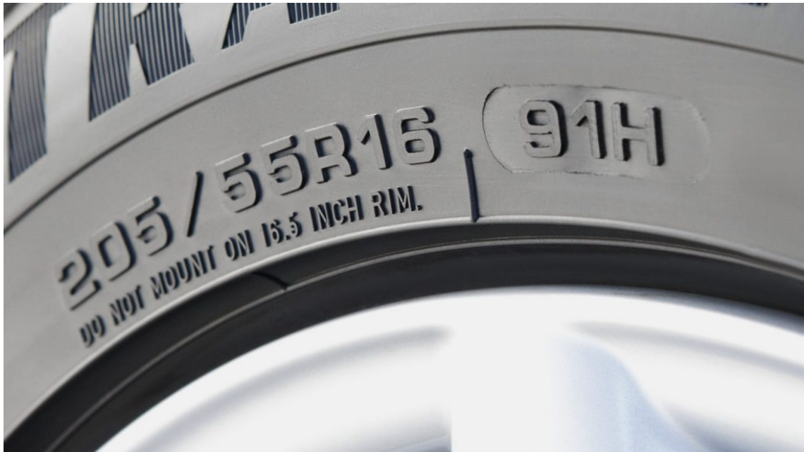
Obrázek č. 24 – Značení pneumatiky [11]
