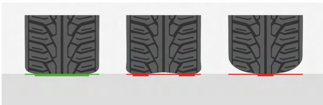
Obrázek č. 30 – Vlevo správně nahuštěná pneumatika, uprostřed podhuštěná pneumatika, vpravo přehuštěná pneumatika [15]
