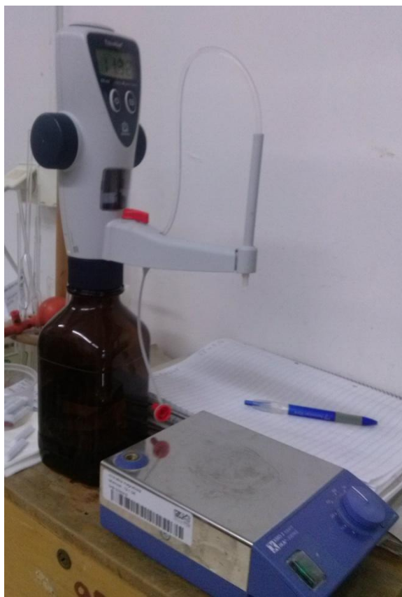
Fotografie č. 17, Stanovení bílkovin, titrační míchadlo s pH metrem
