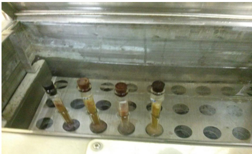
Fotografie č. 13, Stanovení tuku acidobutyrometrickou metodou, temperance butyrometru
