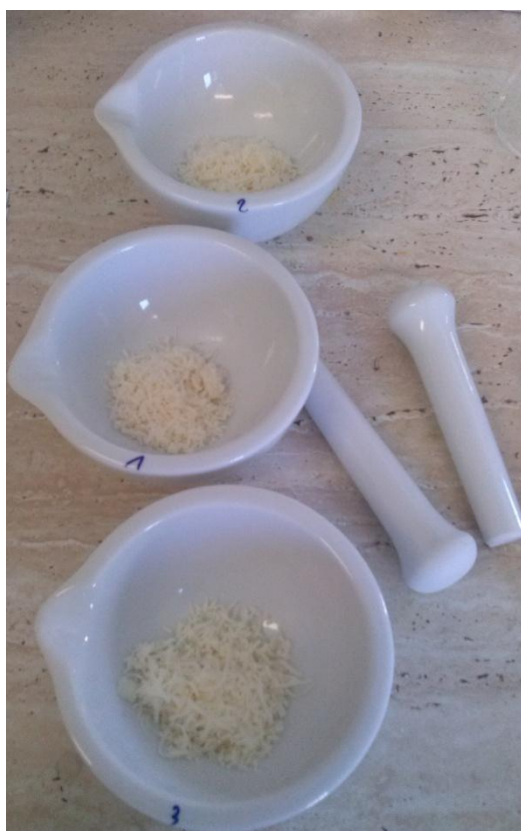
Fotografie č. 14, Stanovení titrační kyselosti, třecí misky s 30 g vzorku
