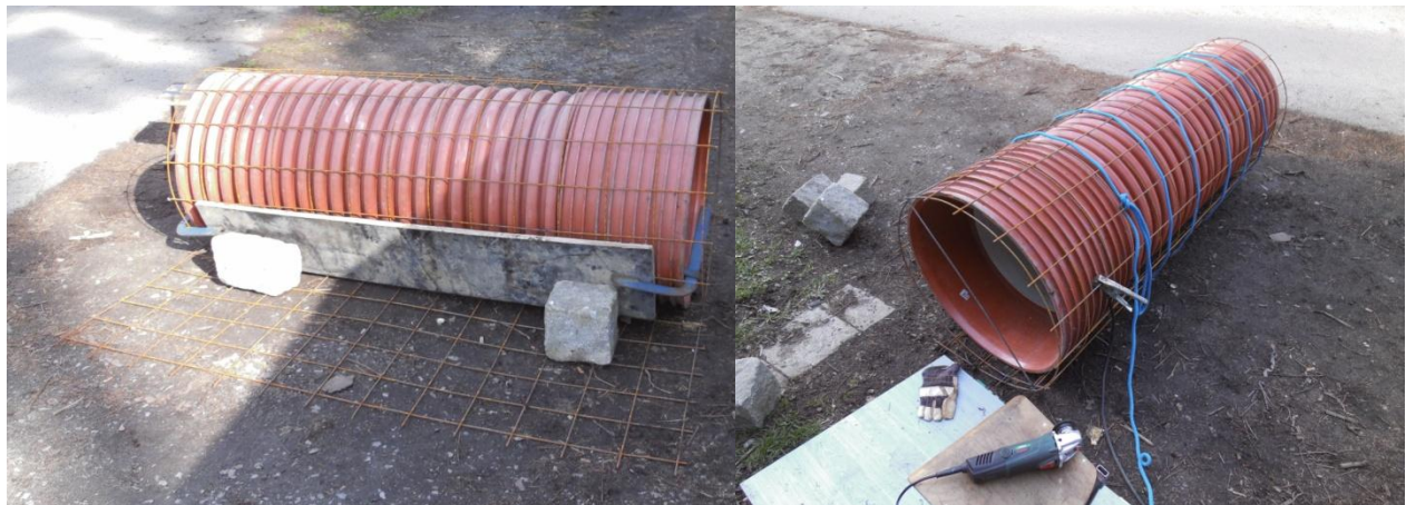
Obr.5.16 vlevo zkružení rotoru před svařením švu, vpravo rotor po navaření středového žebra, před vytažením z kopyta.
