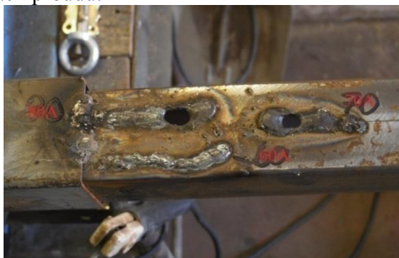
Obr.5.1 Zkušební vzorek pro nastavení parametrů svařování
