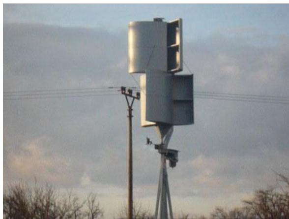
Obr.2.2 Dvoustupňový třílopatkový symetrický Savoniův rotor [3]
