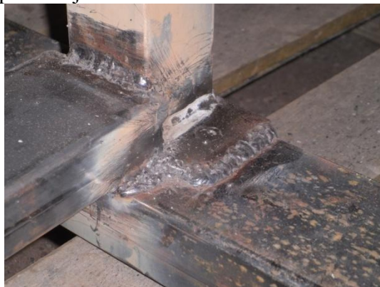
Obr.5.2 Detail svarů rámu
