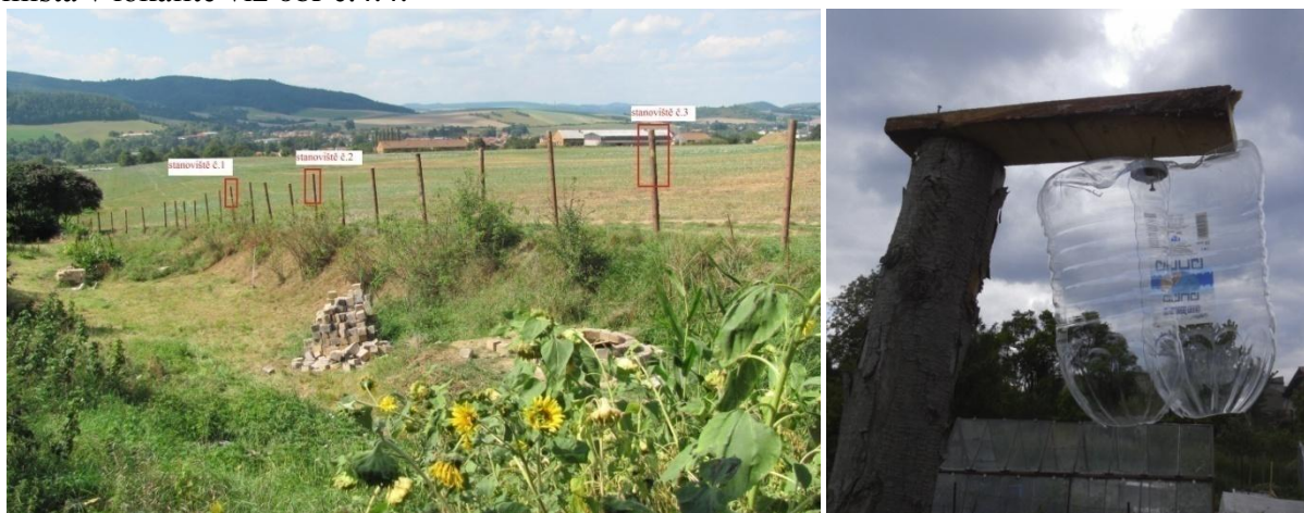
Obr.4.4 Vlevo volba nejvhodnějšího stanoviště v dané lokalitě, vpravo umístění anemometru na stanovišti.
