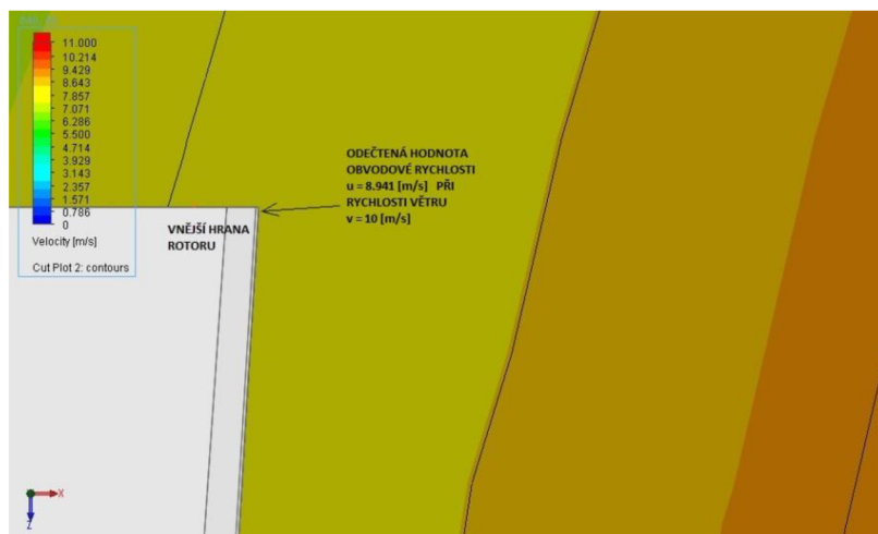
Obr.5.5 Izočáry rychlosti větru na 3D modelu z nichž je odečtena obvodová rychlost na vnější hraně rotoru
