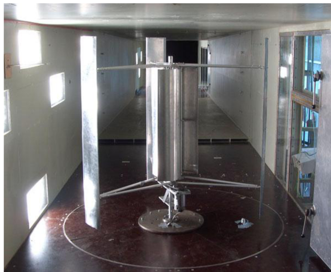
Obr.3.1 Kombinovaný rotor při zkouškách ve větrném tunelu na univerzitě v Liege[11]
