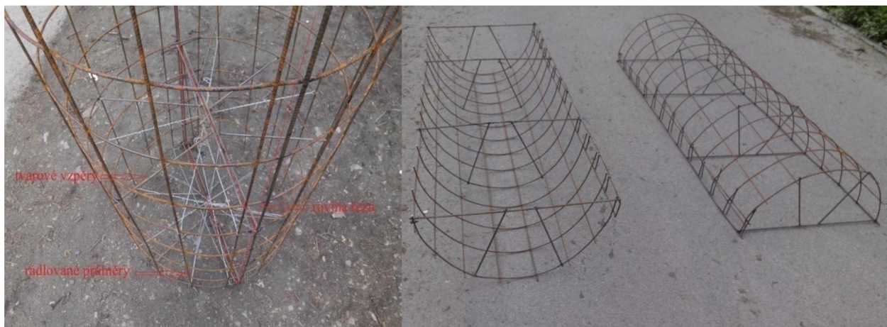
Obr.5.17 vlevo vyrádlovaný rotor, vpravo dvě lopatky rotoru po rozříznutí
