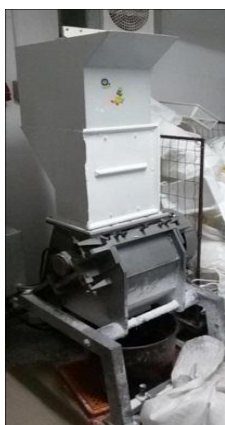
foto č. 5: drtící zařízení (drtí výrobky 2. jakosti)
