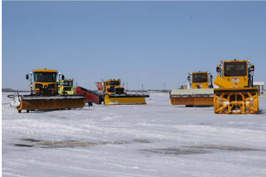
Obr. 12 Zľava: zametač- odfukovač, pluh, zametač, fráza. Zdroj: christopherrobin07.blogspot.com
