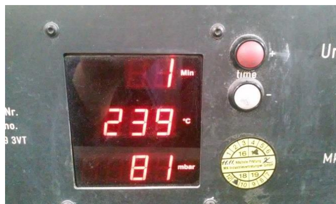
Obr. 9-4 Ukázka zobrazovaných hodnot v průběhu tuhnutí vzorku
