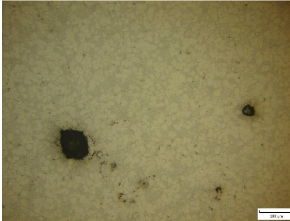
Obr. 10-15 Mikrostruktura odlitku A při nastavení N150, vzduchová pomezita
