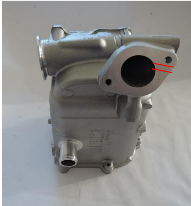
Obr. 6-3 Odlitek typu B a místo odběru vzorku
