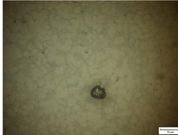
Obr. 10-16 Mikrostruktura odlitku A při nastavení N150, vzduchová pomezita
