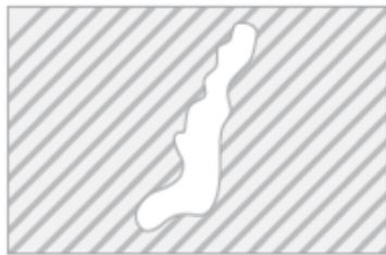
Obr. 5-1 Vada, která nezpůsobuje netěsnost [14]
