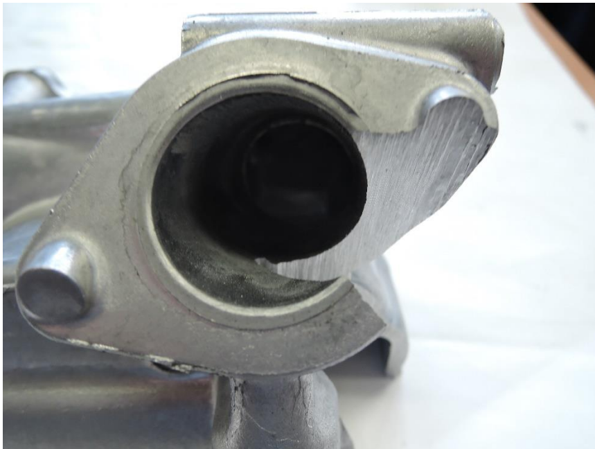
Obr. 6-4 Detail na místo řezu odlitku B
