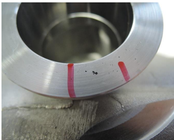
Obr. 10-10 Detail vady na malé přírubě
