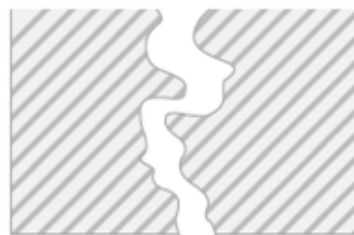
Obr. 5-2 Vada, která způsobuje netěsnost odlitku [14]
