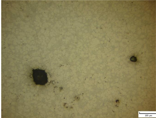
Obr. 10-15 Mikrostruktura odlitku A při nastavení N150, vzduchová porezita
