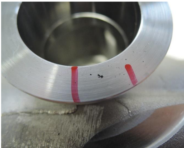
Obr. 10-10 Detail vady na malé přírubě
