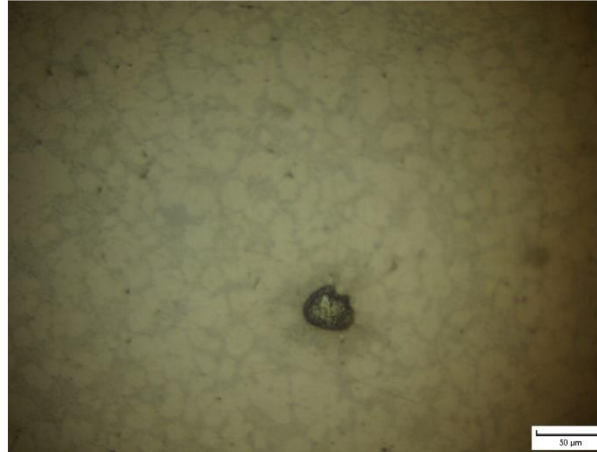
Obr. 10-16 Mikrostruktura odlitku A při nastavení N150, vzduchová porezita
