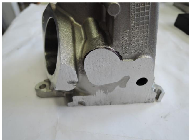
Obr. 6-2 Řezná plocha, pro odběr vzorku z odlitku A
