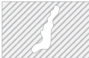
Obr. 5-1 Vada, která nezpůsobuje netěsnost [14]
