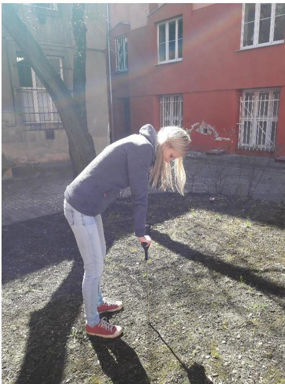
Fotografie č. 2: Měření penetrometrem v terénu (Svobodová M.).
