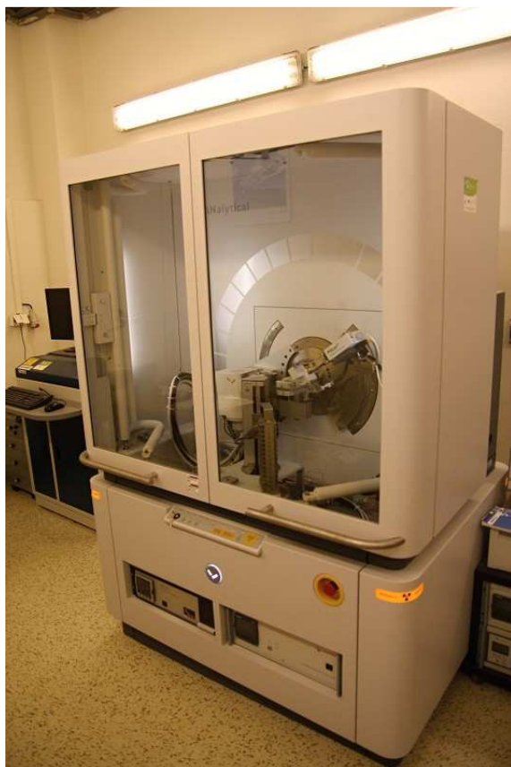
Obrázok 15 Röntgenový difraktometer Empyrean od firmy Panalytical
