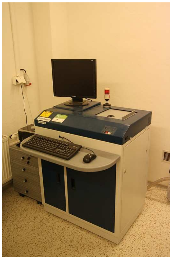
Obrázok 16 Röntgenový fluorescenčný spektrometer EX6600 Xenometrix
