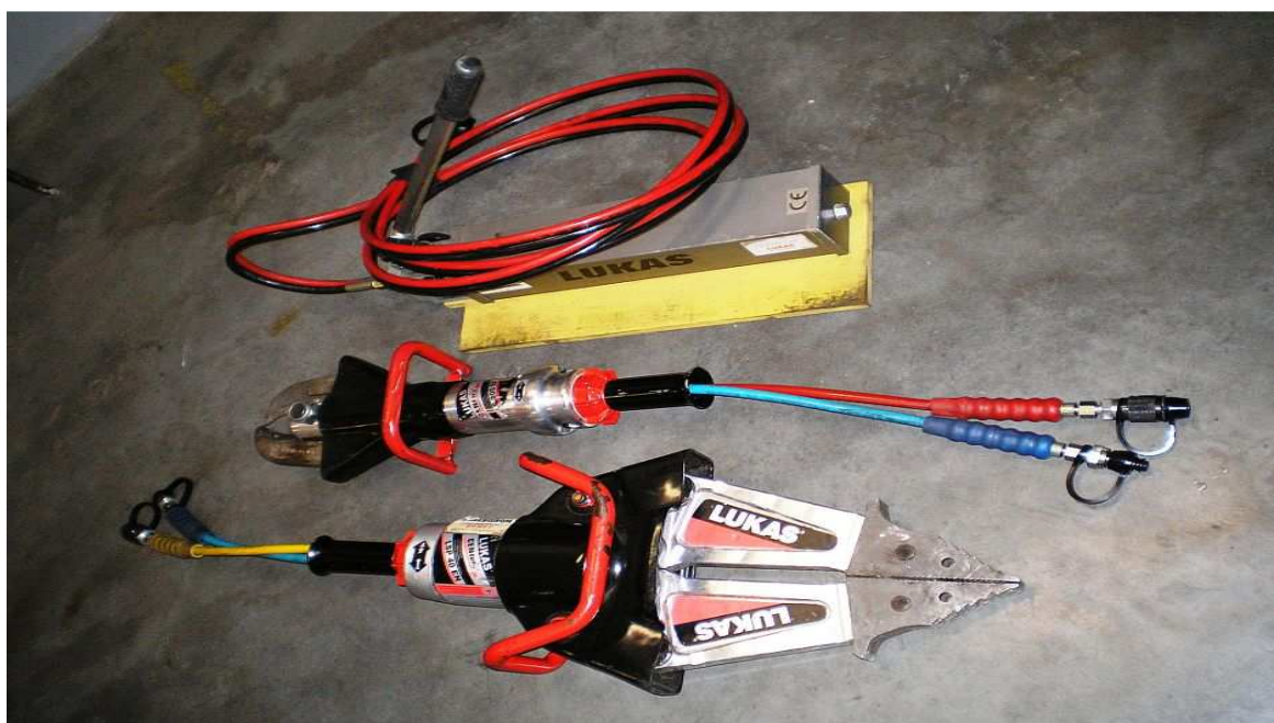
Příloha 18 - Hydraulický rozpínací nástroj LUKAS LSP 40 EN a hydraulické nůžky LUKAS LS 200 EN
