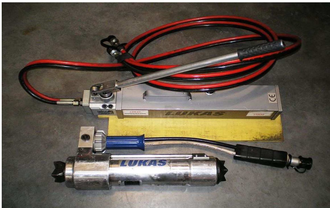
Příloha 17 - Hydraulický rozpěrný válec LUKAS - LTR 12/575 EN a ruční hydraulické čerpadlo LUKAS ZHP ¾
