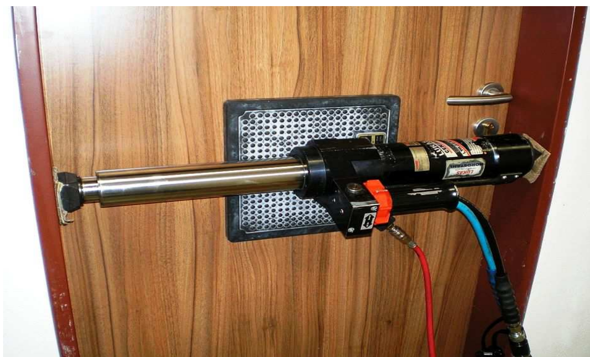
Příloha 38 - Použití rozpínacího hydraulického válce a vysokotlakých vzduchových vaků
