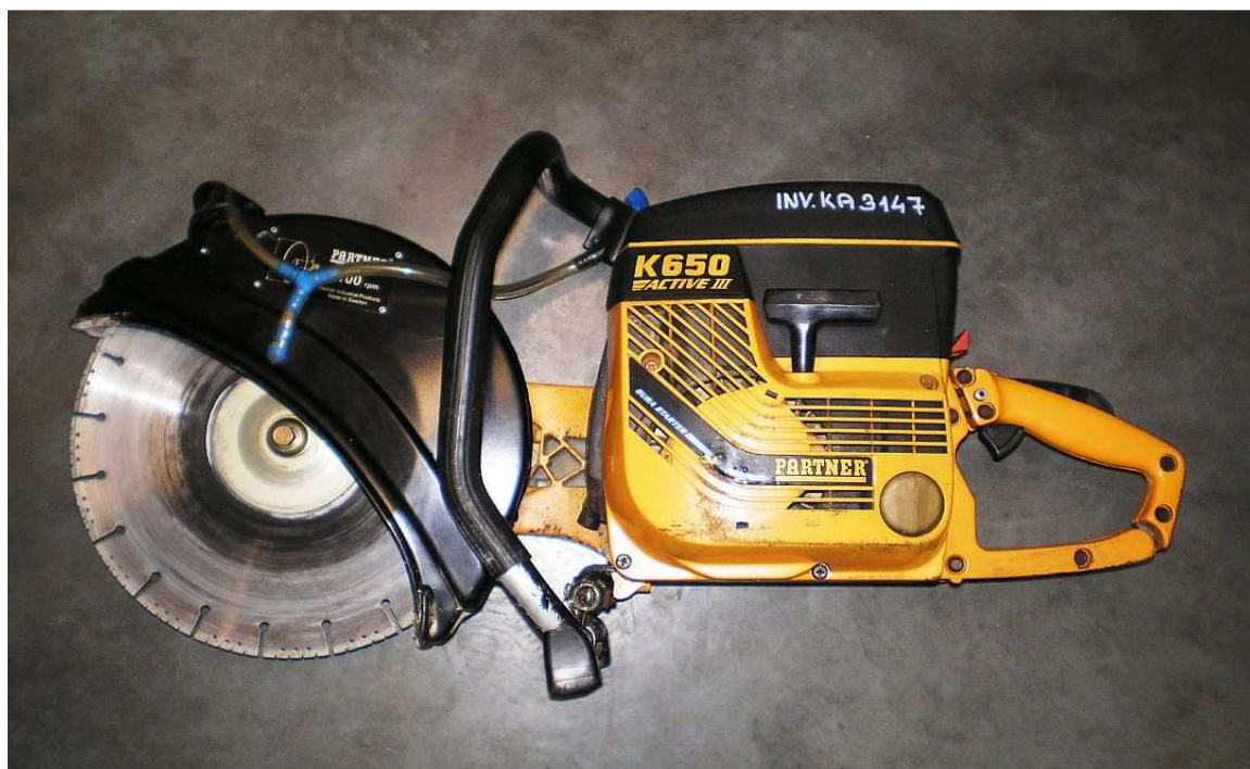
Příloha 21 - Rozbrušovací motorová pila Partner K 650 Active
