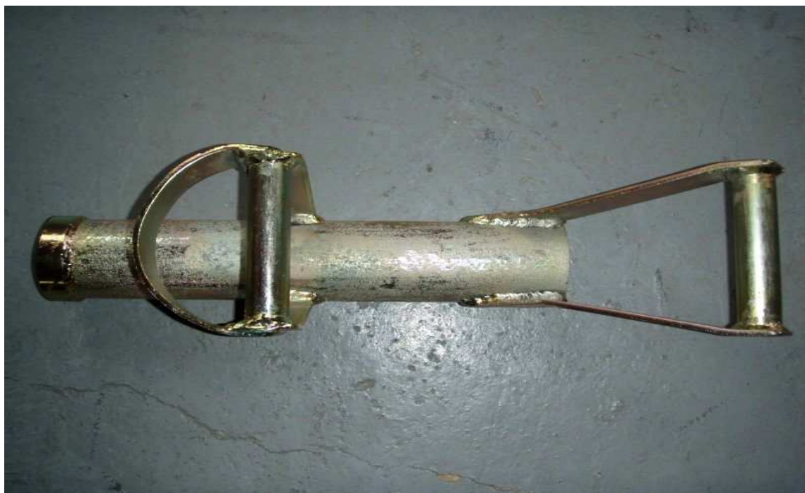
Příloha 65 - Vyrážedlo HZS k destrukční metodě vstupu do uzavřených prostor
