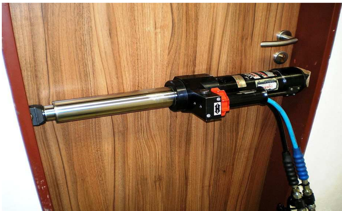
Příloha 37 - Použití rozpínacího hydraulického válce - detail
