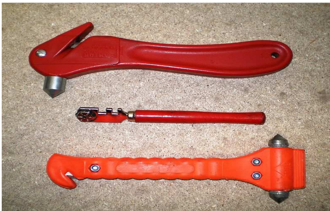
Příloha 13 - Diamantový řezač a kladívkové rozbíječe skla
