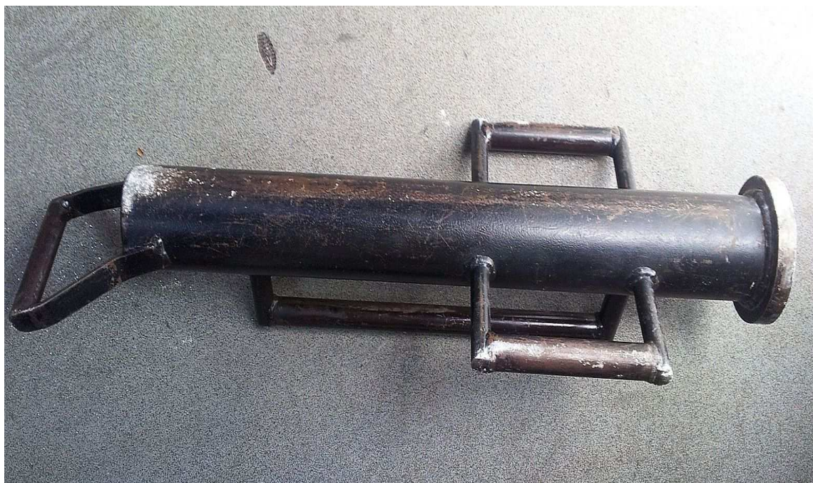
Příloha 65 - Vyrážedlo HZS k destrukční metodě vstupu do uzavřených prostor
