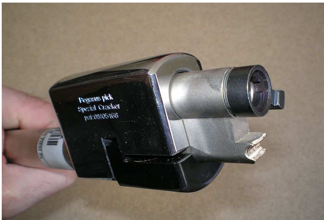
Příloha 51 - Otevírání dveří vylamovači cylindrických vložek
