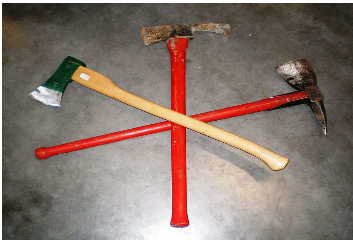
Příloha 7 - Požárnická sekera, bourací sekera a motysekera
