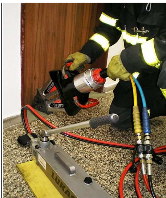
Příloha 39, 40 - Použití hydraulického rozpínací nástroje
