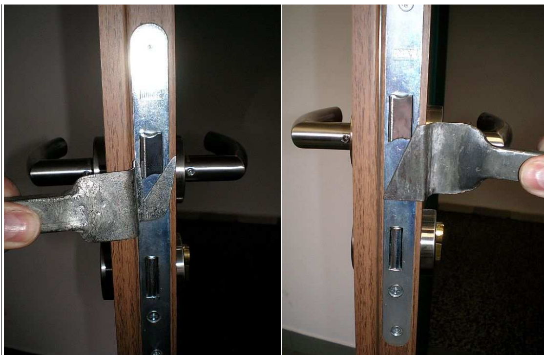
Příloha 47, 48 - Otevírání dveří zárubňovými pazetami
