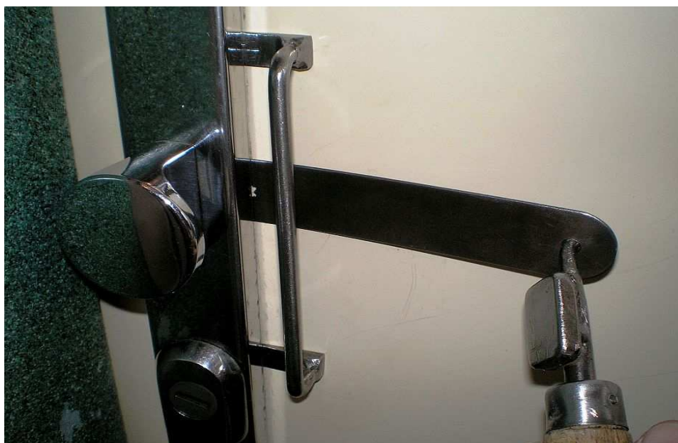
Příloha 83 - Pracovní postup při vytahování zubaté planžety
