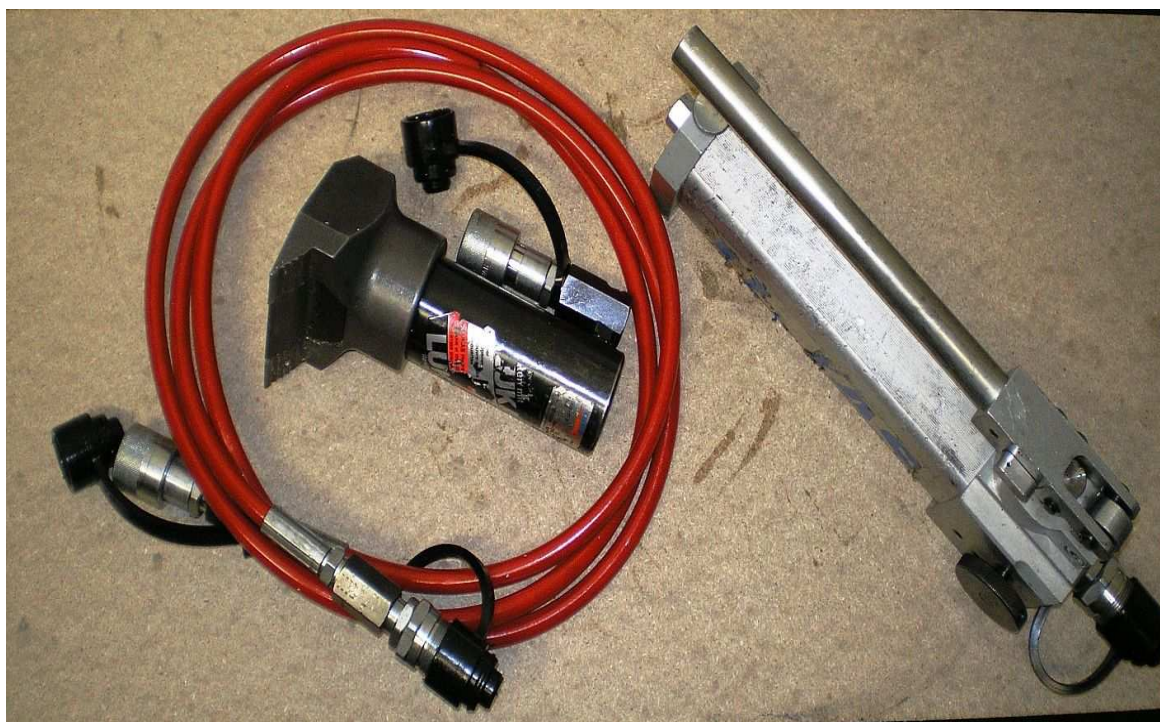
Příloha 15 - Hydraulický otvírač dveří LUKAS HTS 90
