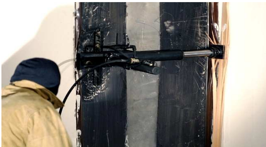
Příloha 63 - Metodika vstupu do uzavřených prostor zásahovou jednotkou Policie ČR (rozpínání)
