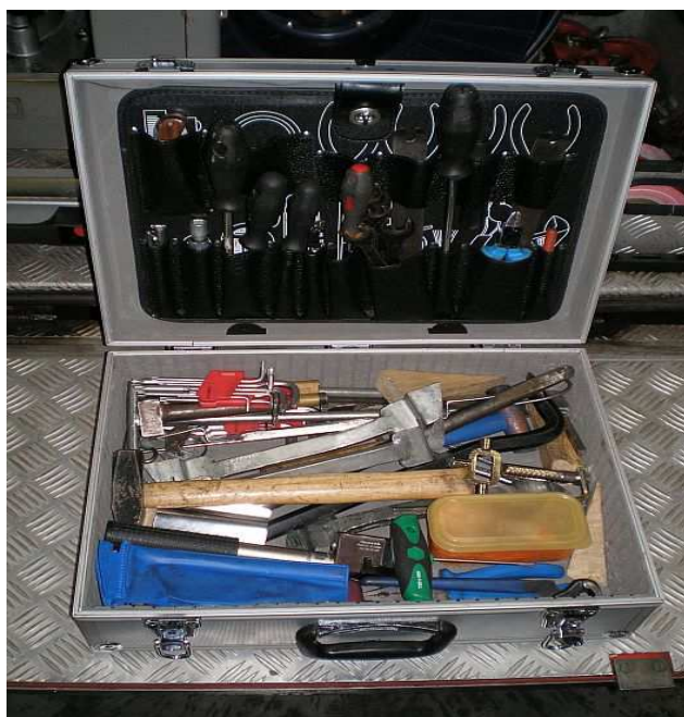
Příloha 68 - Vybavení kufříku základním nářadím k otevírání uzavřených prostor
