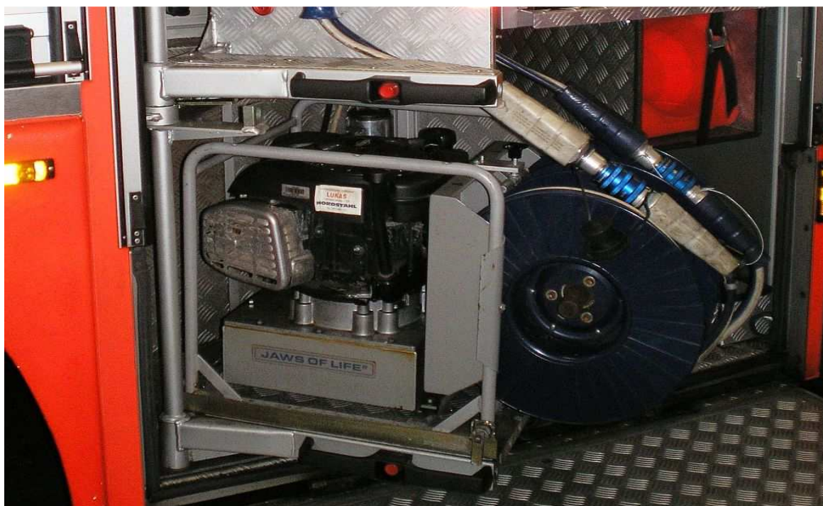
Příloha 19 - Hydraulický motorový agregát LUKAS GS-6T
