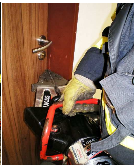
Příloha 39, 40 - Použití hydraulického rozpínací nástroje
