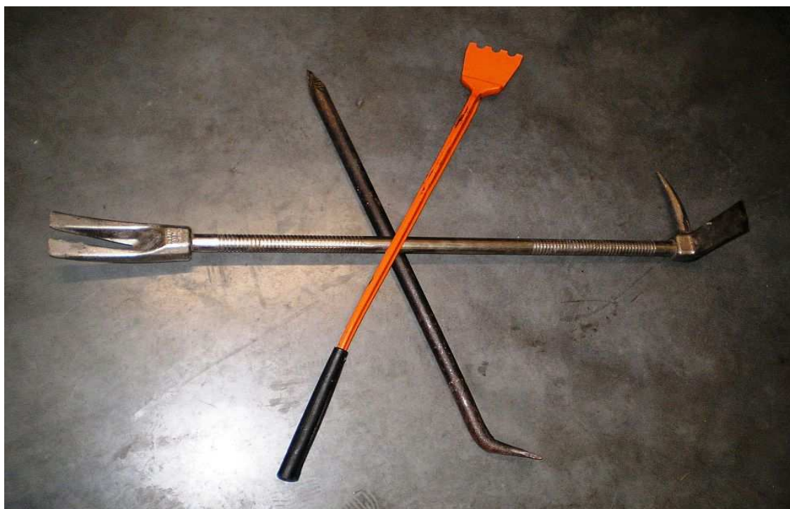
Příloha 9 - Páčidlo Halligan tool, ocelové páčidlo tyčové a dřevorubecká lopatka
