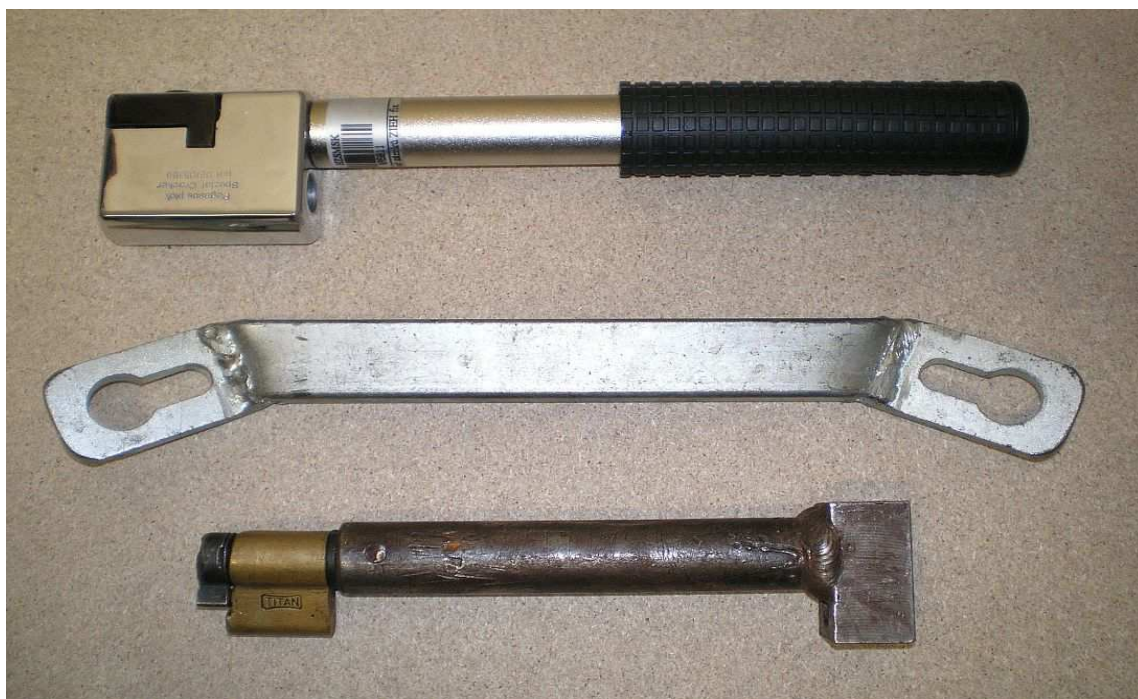
Příloha 11 - Vylamovače cylindrických vložek zámků
