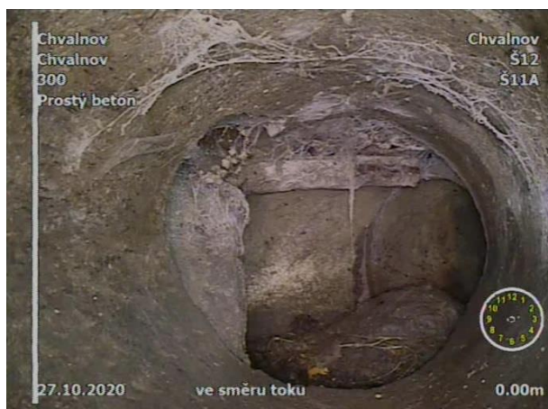
Obr. 40 Kamerový záznam Š12-Š11A [zdroj foto: V. Shamko]
