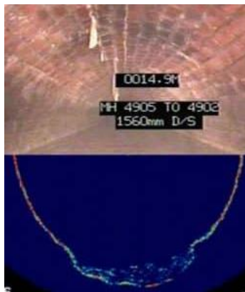
Obr. 24 Výstup 360° při použití CCTV kamery a sonaru [35]
