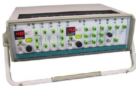
Obr. 6.1: měřicí modulární laboratorní sestava EDFA
