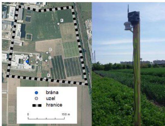
Obr. 12. Druhá konfigurace uzlů v prvním klastru (vlevo), upevnění uzlů v terénu (vpravo)
