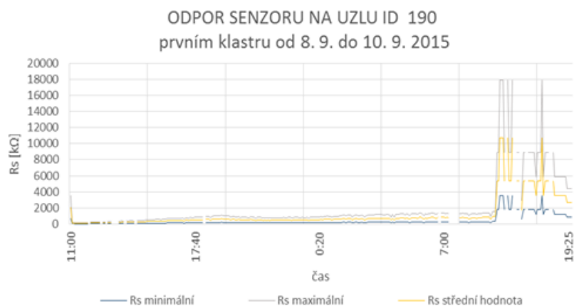
Obr. 90. Odpor senzoru NO 2 při rozdílných zatíženích senzoru na uzlu ID 190 v prvním klastru od 8. 9. do 10. 9. 2015, zdroj: vlastní měření
