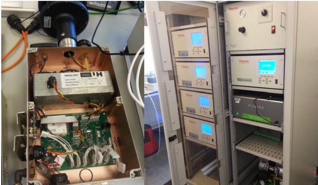
Obr. 19. Uzel se základní deskou (uvnitř obalu) a senzory (vyčnívající na levé straně z krytu) (vlevo), kalibrační stanice (vpravo), zdroj: vlastní fotografie
