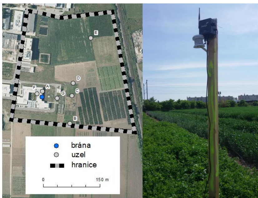
Obr. 45. Polohy uzlů v Holici od 3. 9. 2015, ukázka upevnění uzlu na dřevěné tyči v terénu, zdroj: vlastní tematická složka, ortofoto ČÚZK, vlastní fotografie
