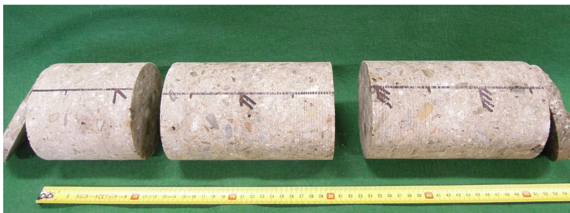
Obr. 2.20: Jádrový vývrt rozdělený na jednotlivé vzorky
