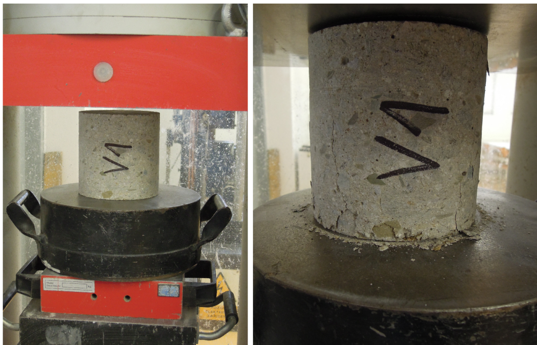
Obr. B.5: Vzorek V1 před a po zkoušení ve zkušebním lisu
