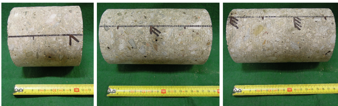
Obr. B.3: Zkušební vzorky z jádrového vývrtnu
