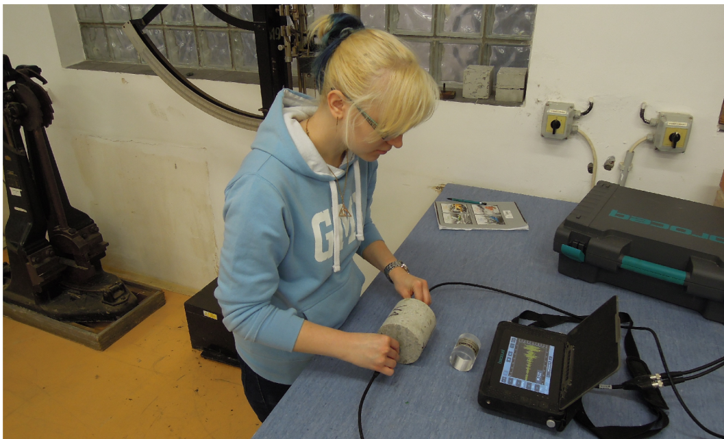
Obr. B.4: Měření vzorku V1 UZ impulsovou metodou
