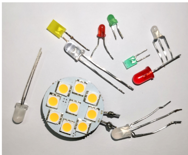
Obrázek 2.11: Schématická značka LED a její různá provedení.
